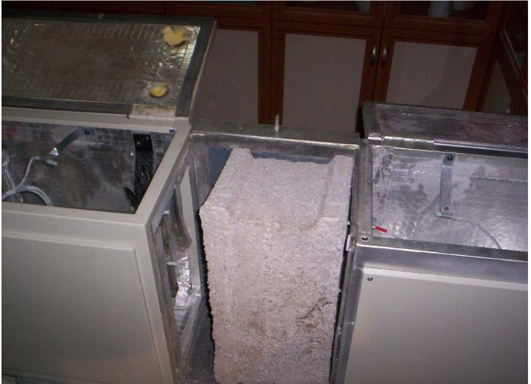
Resim 3.4. Isı iletkenlik katsayısı ölçüm cihazı
