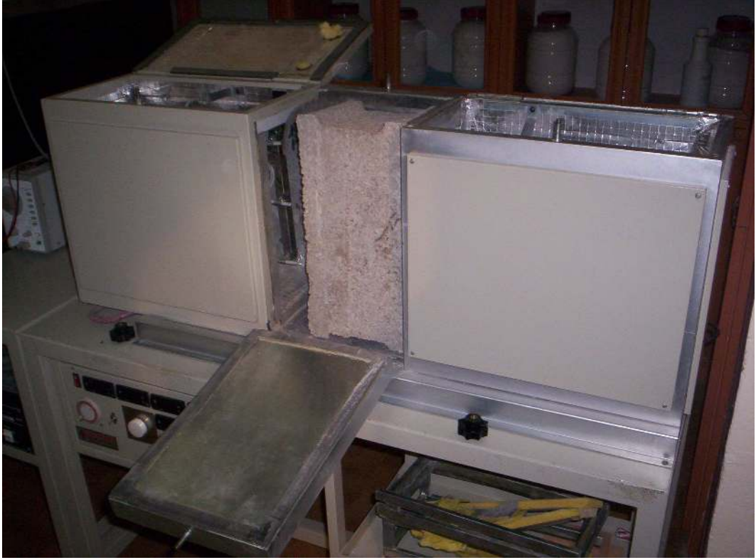
Resim 3.3. Isı iletkenlik katsayısı ölçüm cihazı
