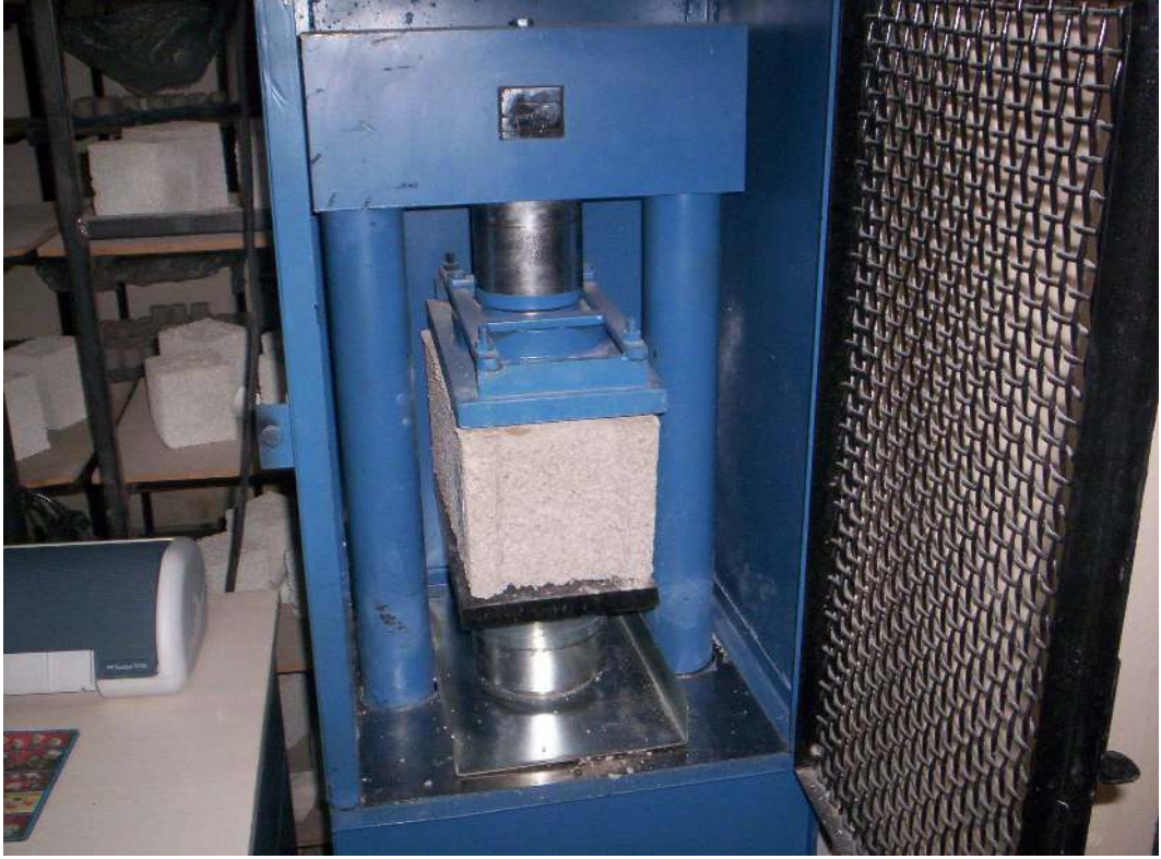
Resim 3.2. Basınç dayanımı ölçme cihazı
