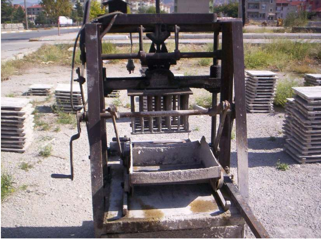
Resim 3.1. Numunelerin üretildiği briket makinesi
