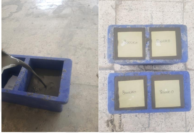
Resim 3.6 Homojen harcın kp kalıplara yerleřtirilmesi.
