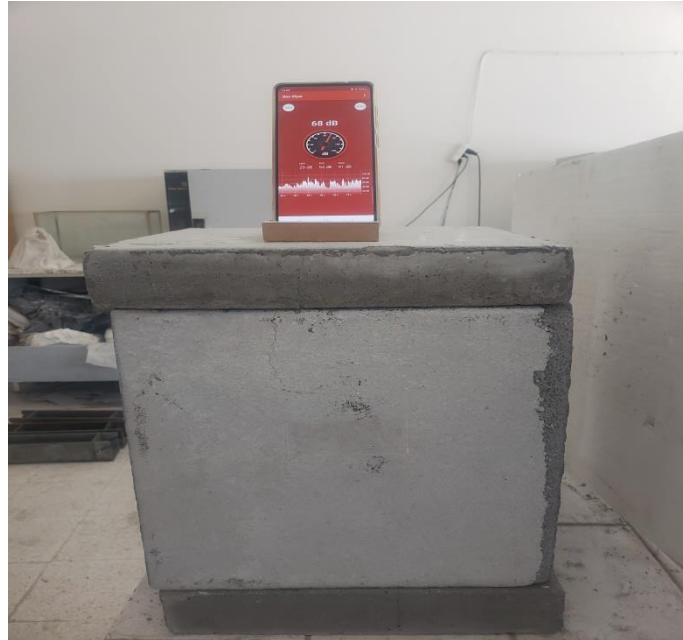
Resim 3.28 Kutu kapalı haldeyken akustik özellik simülasyon deneyi.
