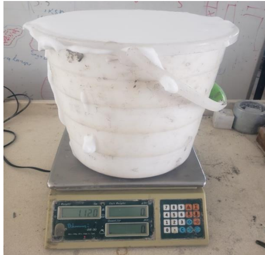
Resim 3.5 Karışıma ilave edilecek köpüğün birim ağırlık ölçümü.
