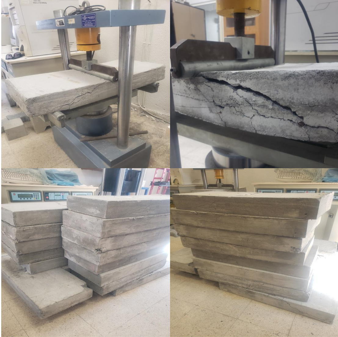
Resim 3.24 800x340x100 mm donatılı numuneler için eğilme dayanımı testi uygulanması.
