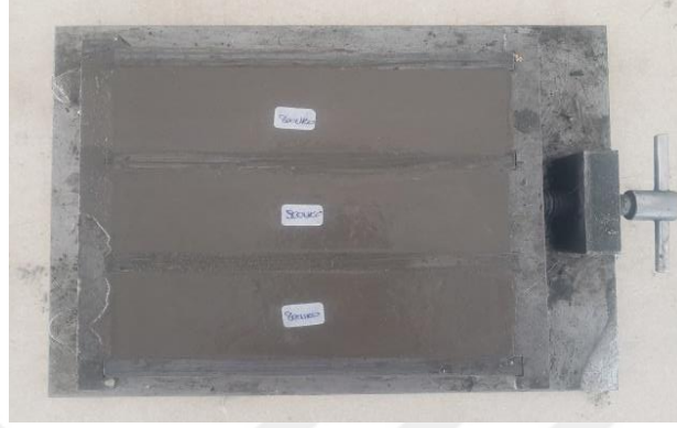
Resim 3.8 Homojen harcın plaka kalıplara yerleştirilmesi.
