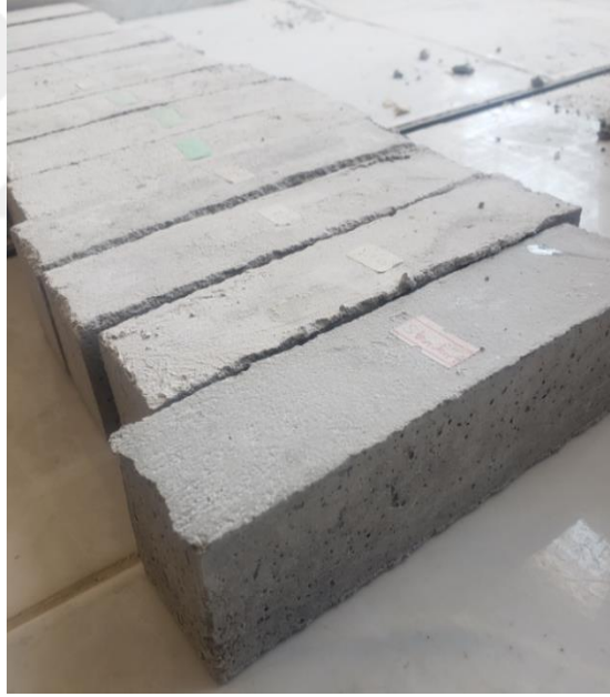
Resim 3.18 Rölatif uzunluk değişimi için üretilen numuneler.
