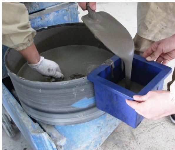
Resim 3.3 Hazırlanan harçtan mikserde homojen karışımın elde edilmesi.
