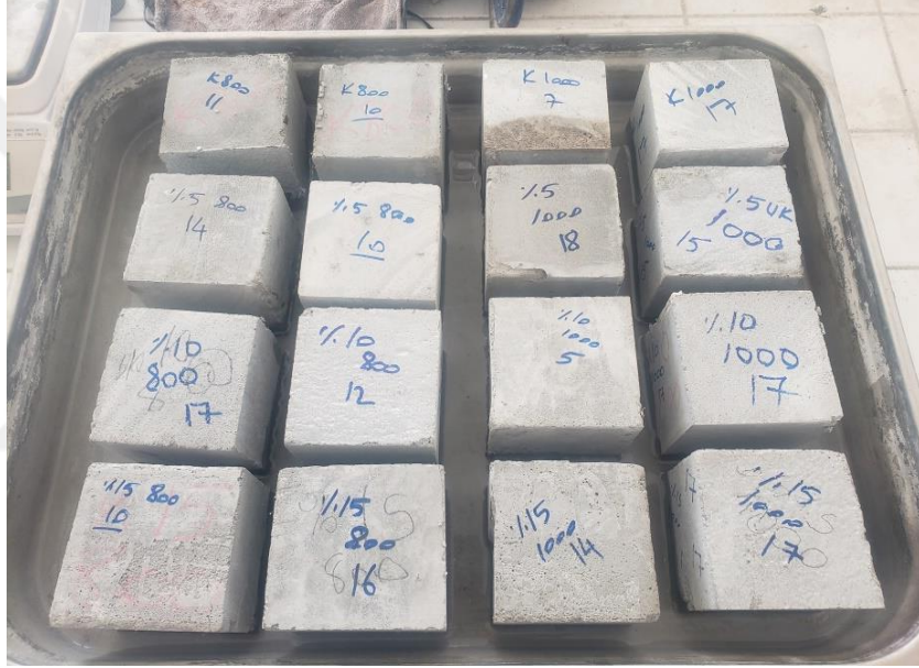
Resim 3.21 Numunelerin kılcal su emme deneyi ölçümlerinin yapılması.
