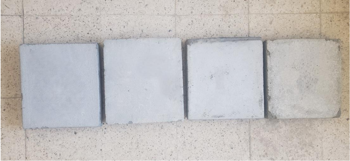
Resim 3.25 Zamana bağlı yüzey geçiş sıcaklığı simülasyon testi için üretilen 300x300x50 mm plaka numuneler.
