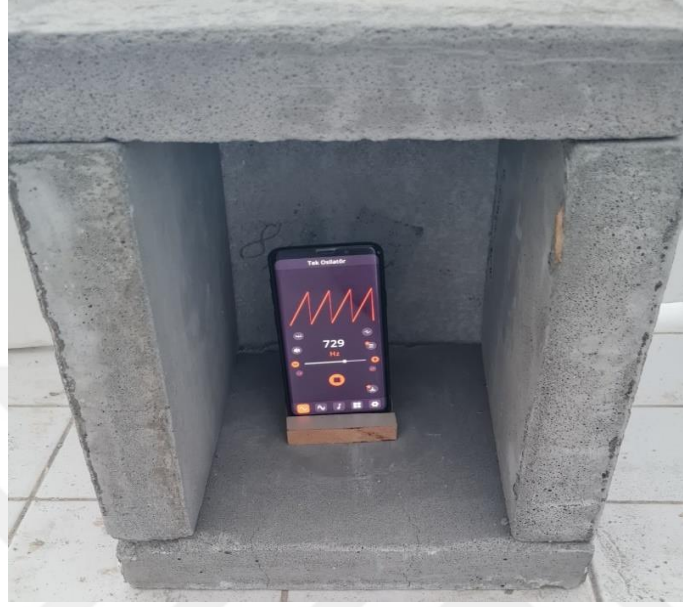
Resim 3.27 Ses kutusu ile akustik özellik simülasyon deneyi.
