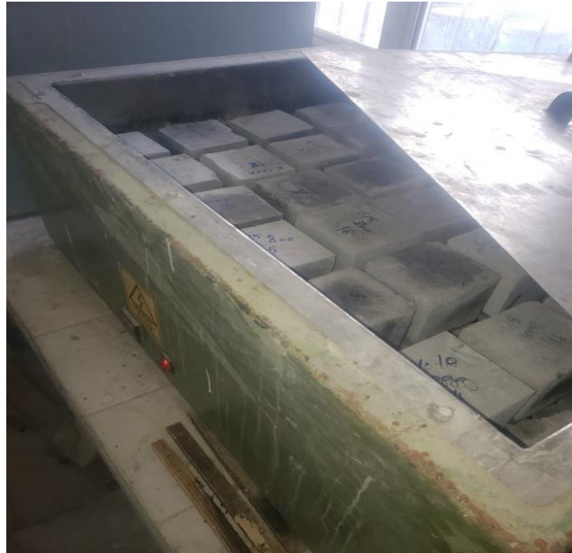
Resim 3.11 Numunelerin buhar kürüne tabi tutulması işlemi.
