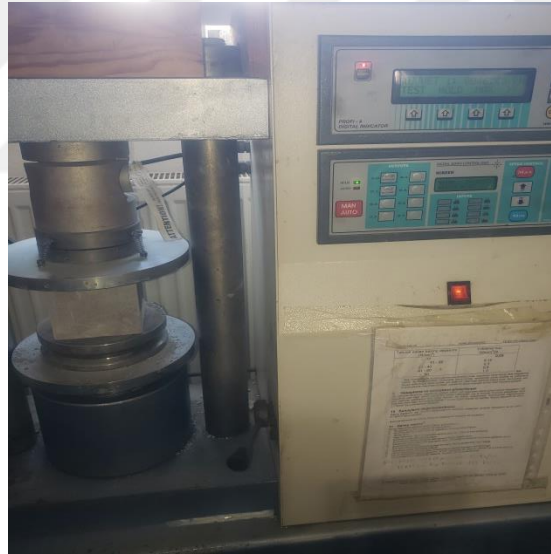
Resim 3.22 100x100x100 mm boyutlarındaki küp numunelerin basınç dayanım testi.
