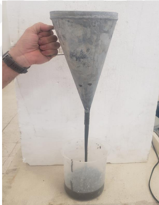
Resim 3.14 Marsh konisi ile kıvam analizi.
