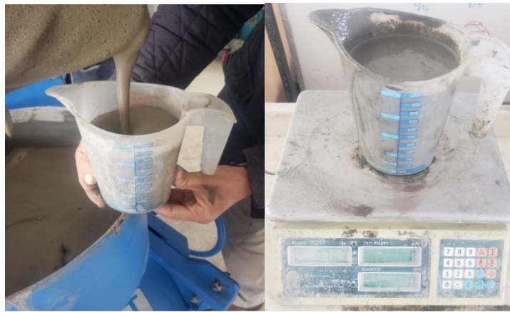
Resim 3.13 Homojen harcın  l  m kabına doldurulması ve tartım yapılması.
