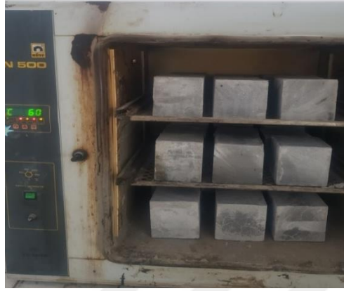
Resim 3.12 Numunelerin et v kuru hale getirilmesi.
