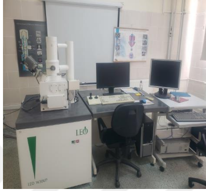
Resim 3.32 Leo 1430 VP model elektron mikroskobu.
