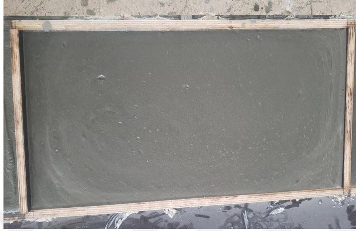
Resim 3.10 Harç yerleştirilmiş duvar panel kalıbı.
