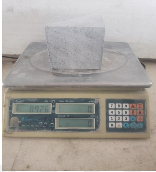
Resim 3.16 100x100x100 mm boyutlarındaki küp numunelerin etüv kurusu ağırlık tartım işlemi.
