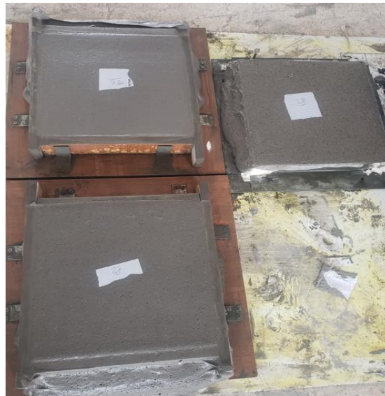
Resim 3.7 Homojen harcın plaka kalıplara yerleřtirilmesi.
