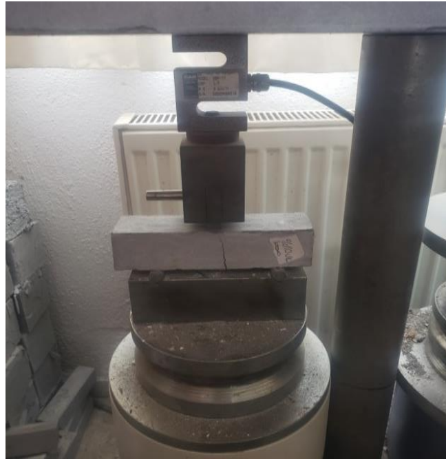
Resim 3.23 40x40x160 mm numuneler için eğilme dayanımı testi uygulanması.
