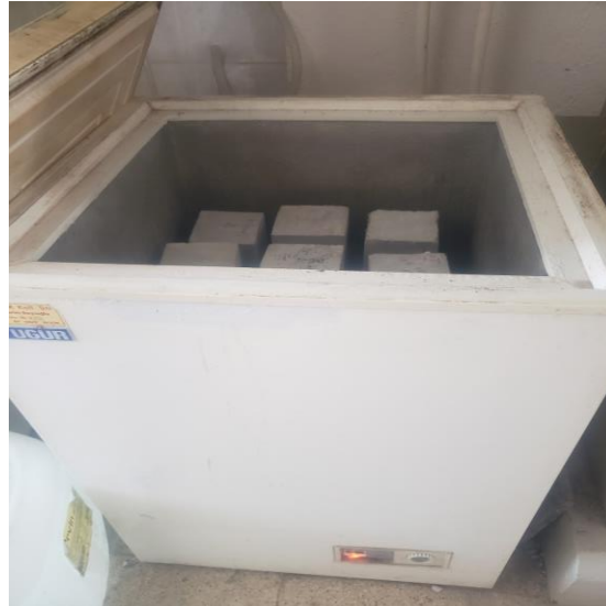
Resim 3.29 Derin dondurucuda -18^{\circ}\text{C} 'de çevrime sokulan örnekler.
