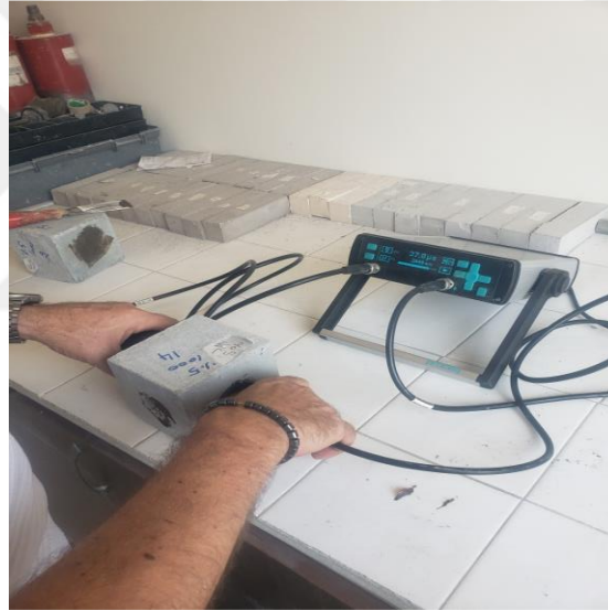
Resim 3.20 Numunelerin ultrases geçiş hızı ölçümlerinin yapılması.
