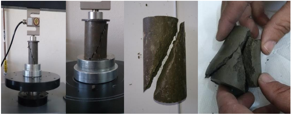
Şekil 3.10: Numunelerde gözlenen yenilme düzlemleri.
