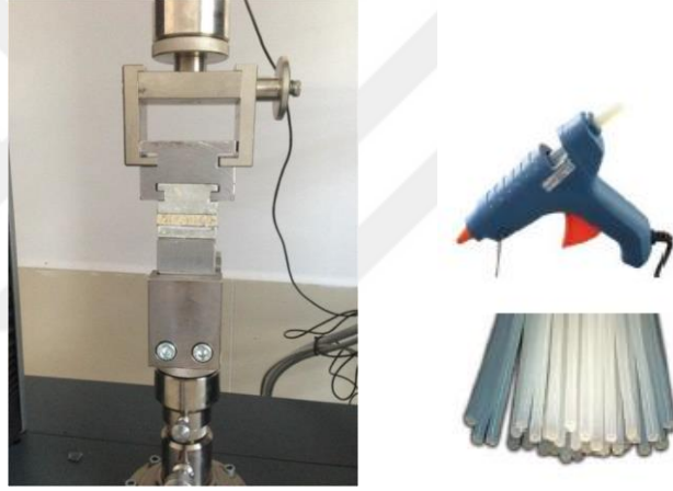
Şekil 16. Yüzeye dik çekme direnci deney düzeneği ve mum silikon
