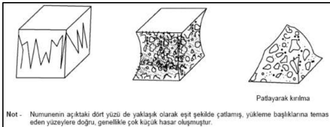
Şekil 4.9. Küp numunenin tatmin edici kırılma şekilleri (TS EN 12390-3, 2003).
