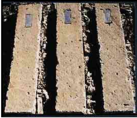
Şekil 3.7. Sülfat saldırısına uğramış yüksek dayanımlı ve katkılı beton (Yazıcı, 2014).
