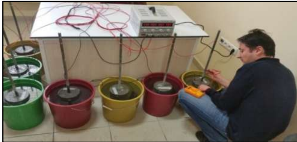
Şekil 4.14. Hızlandırılmış korozyon deney düzeneği.
