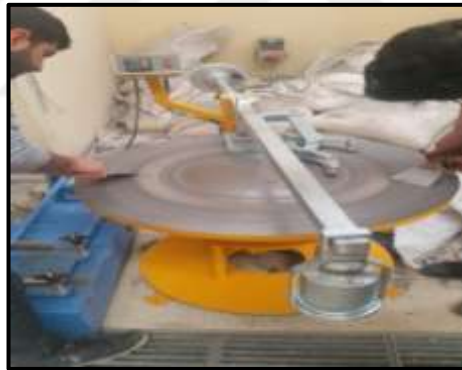
Şekil 4.12 Böhme aşınma deneyi uygulaması.
