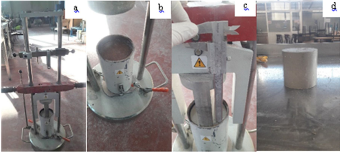
Şekil 3.23 Nemlilik şartları değeri deney süreci a) deney ekipmanı b) numune ve ahşap diskin kalıpla ekipmana sabitlenmesi c) penetrasyon ölçümü d) deney sonunda numune.
