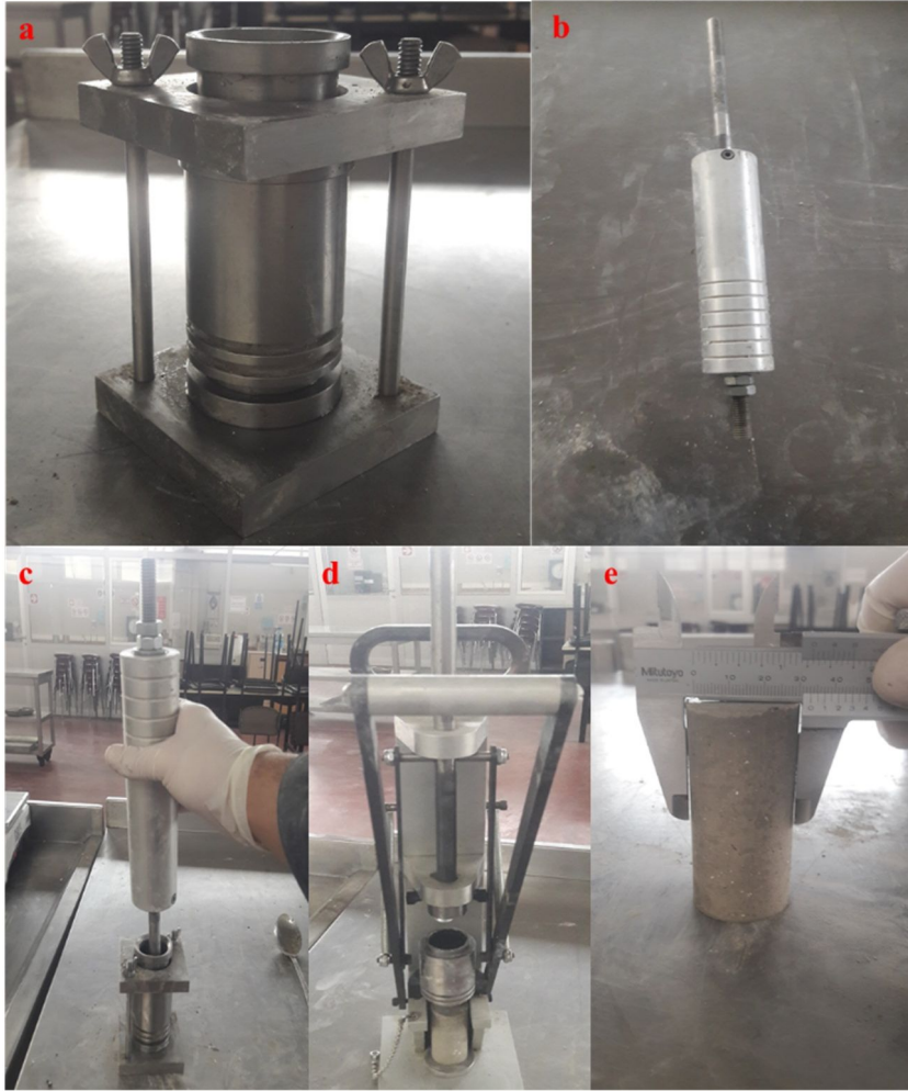
Şekil 3.22 Harvard numune hazırlama süreci a) Harvard mini kompaktör kalıbı b) Tokmak c) Numunenin sıkıştırılması d) Numunenin çıkarılması e) Numune boyut ölçümü.
