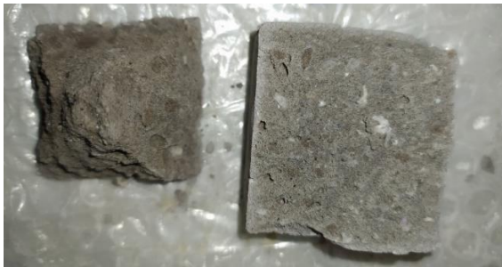
Şekil 4.7. Uçucu kül agregası numunesinin eğilmede çekme dayanım testi sonrası kırılma yüzeyi
