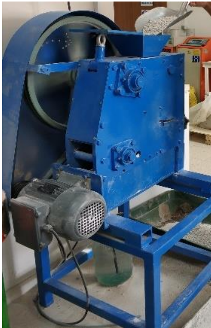
Şekil 3.9. UKA'nın laboratuvar tipi çeneli kırıcıda ince agregaya haline getirilmesi
