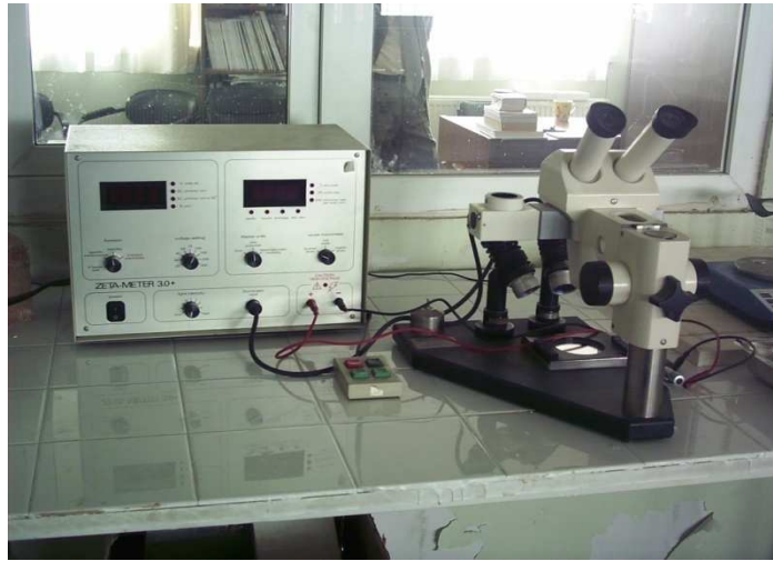
Resim 3.5 Zeta-Meter 3.0 Cihazının Genel Görünüşü
