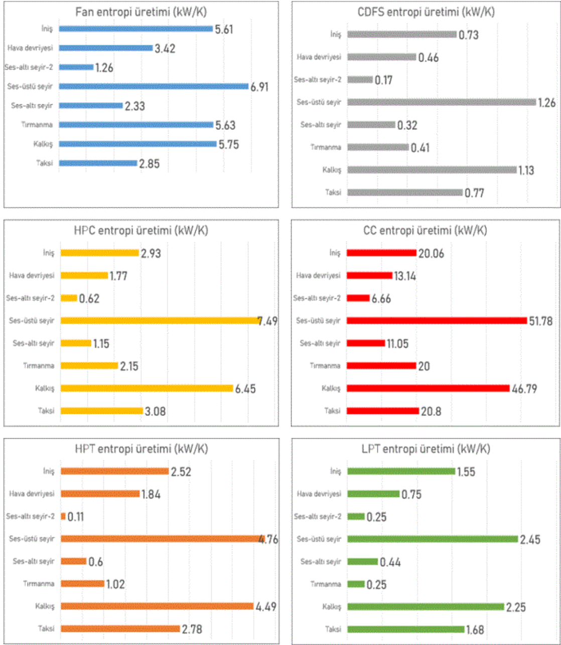
Şekil 6.5. Uçuş fazlarında komponentlerin entropi üretimi (kW/K)
