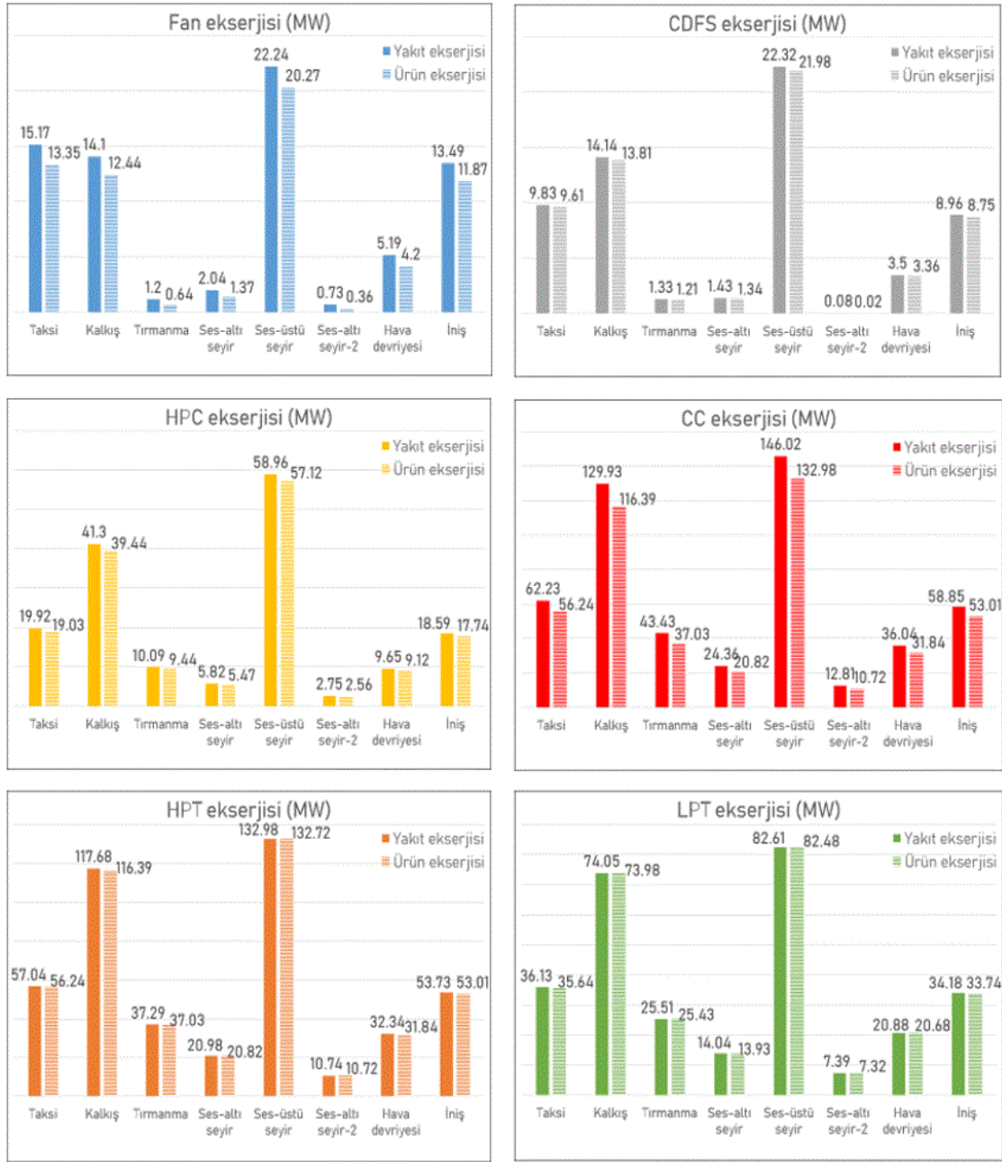
Şekil 6.43. Sekiz uçuş fazı boyunca ana komponentlerdeki yakıt ve ürün ekserjisi
