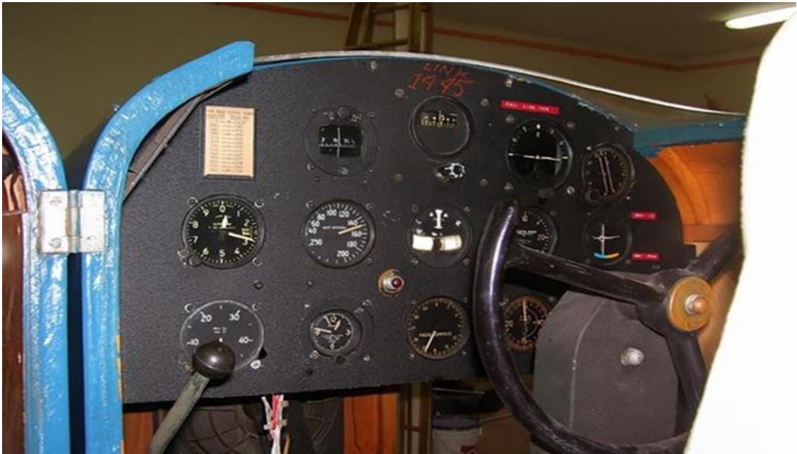
Şekil 2.2. 1930’lu yıllarda geliştirilen “Link Trainer” isimli uçuş simülatörü [33]
