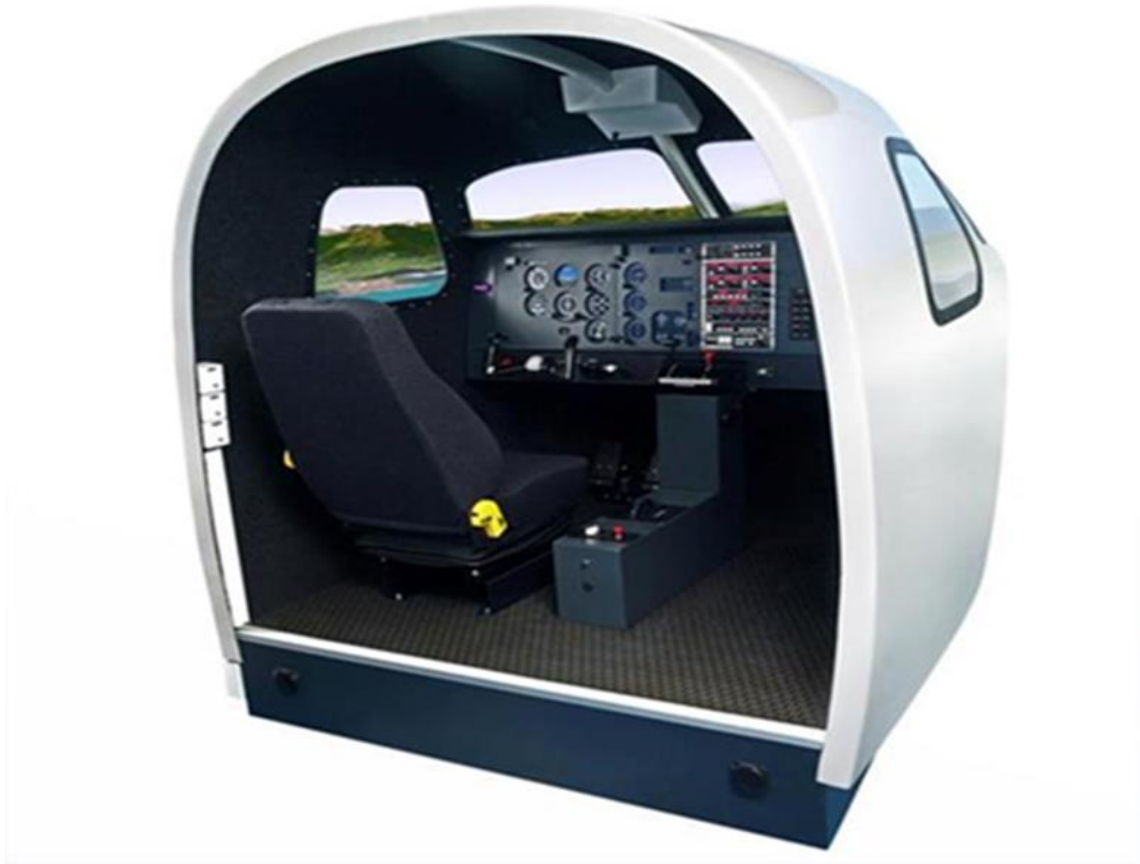
Şekil 2.10. EASA onaylı EASA CS-FSTD(A) standardına uygun BITD cihazının kokpiti [74]
