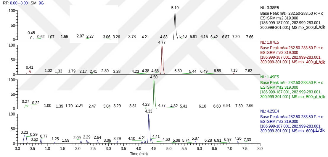
Şekil 4.50. Zearalenon için farklı akış hızlarına ait kromatogramlar
