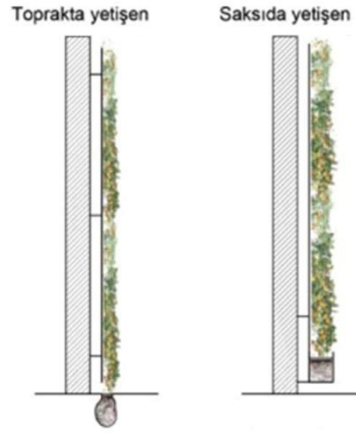
Şekil 4.3. Yeşil cephe uygulama yöntemleri (Erdoğan, 2014)
