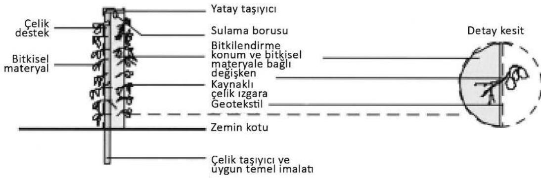
Şekil 4.13. Destekli bio-bariyer dikey duvar uygulaması
