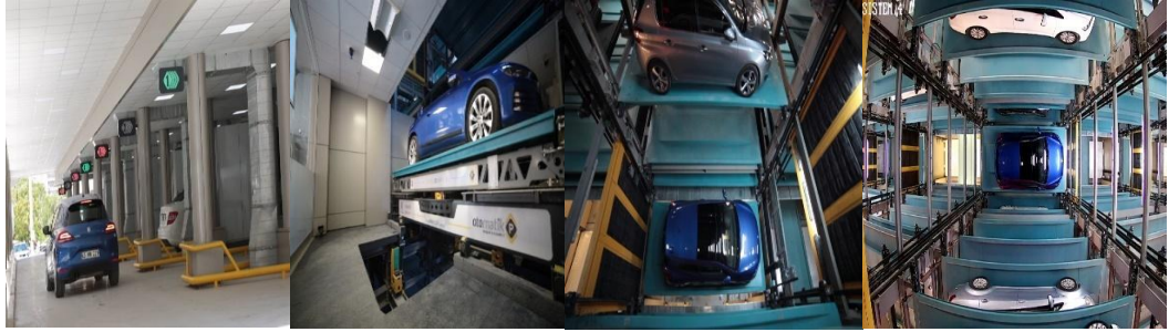
Şekil 5- 4: Tam Otomatik Park Sistemi [283]
