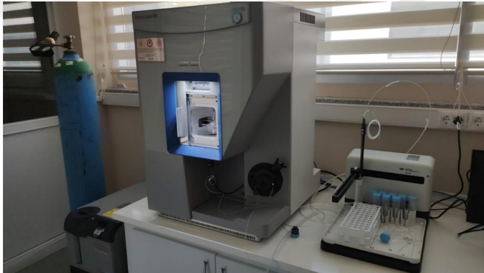
Şekil 3.4. Mineral madde analizleri için kullanılan mikrodalga sistemi ve ICP-OES sistemine ait görüntüler
