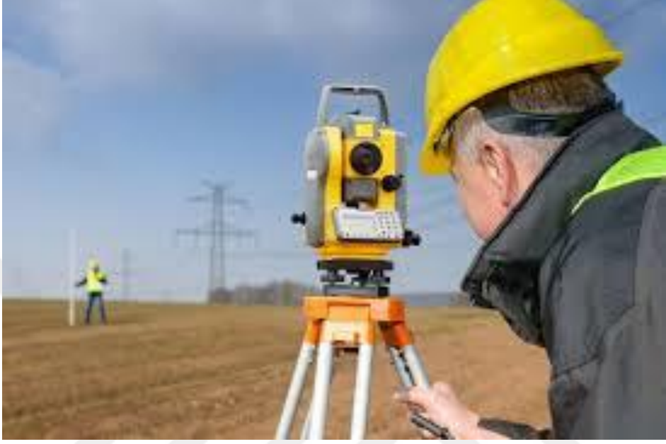
Şekil 10. Totalstation ile kot (yükseklik) ölçümü
