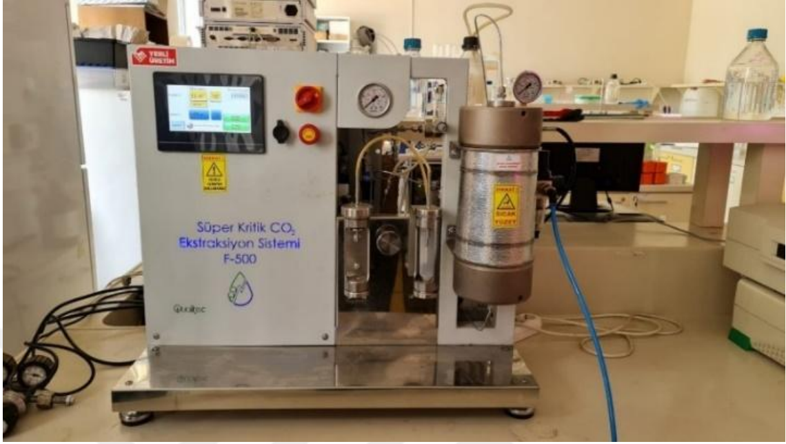
Şekil 3.3. Çalışmalarda Kullanılan Süperkritik Akışkan CO 2 Ekstraksiyonu Sistemi
