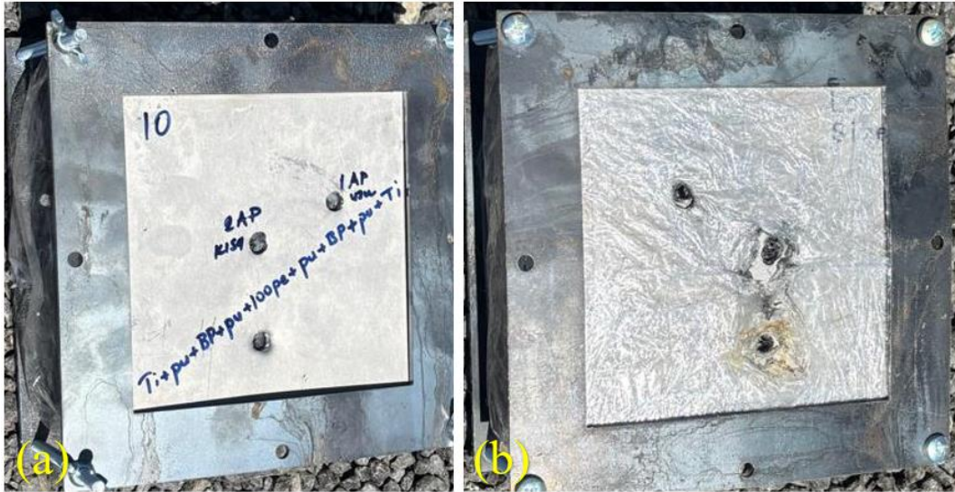
Şekil 4.39 : ti+pu+bp+pu+100pe+pu+bp+pu+ti hedef numune hasar durumu (a) ön yüz, (b) arka yüz
