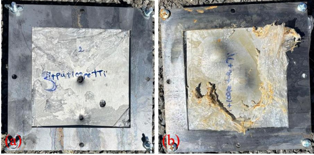
Şekil 4.28 : ti+pu+100pe+ti hedef numune hasar durumu (a) ön yüz, (b) arka yüz
