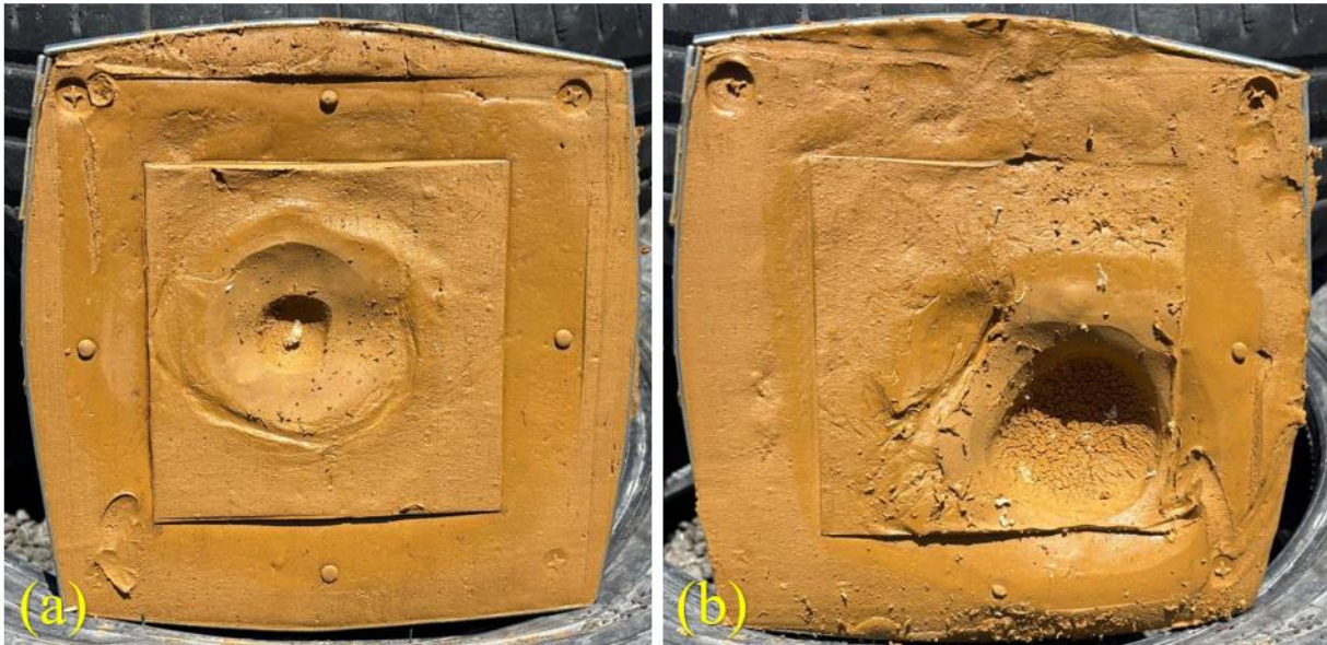
Şekil 4.33 : ti+100pe+ti arka yüz çöküntü miktarları (a) 7,62x51 mm (kısa namlulu), (b) 7,62x51 mm (uzun namlulu)
