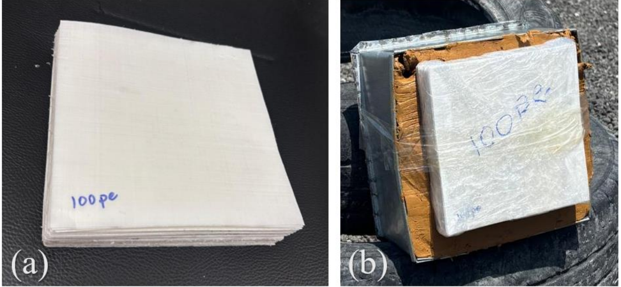
Şekil 4.19 : uhmwpe kumaş (a) 100 tabaka hedef, (b) hedef ve macun yerleşimi
