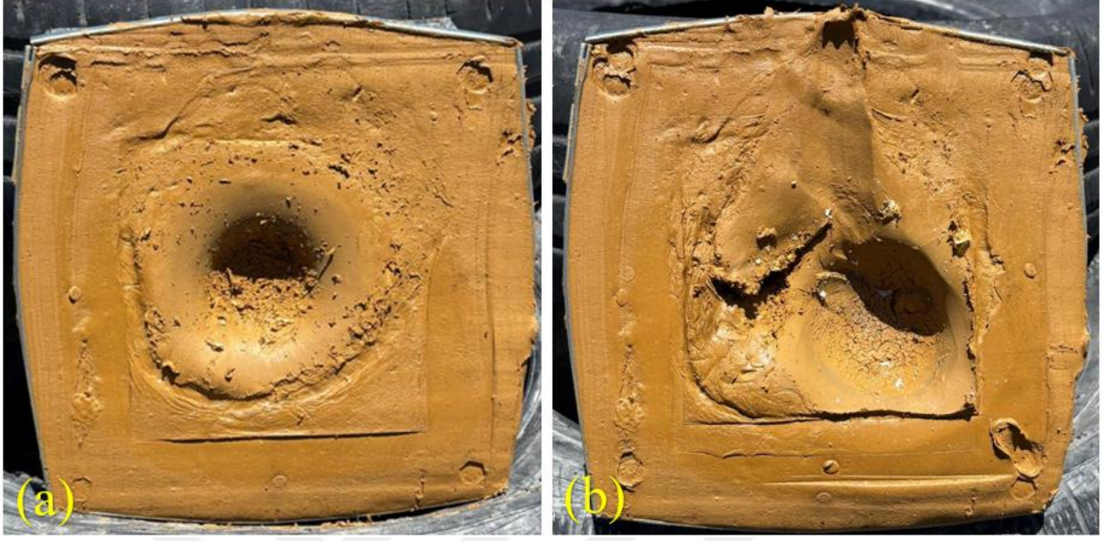
Şekil 4.36 : ti+bp+100pe+bp arka yüz çöküntü miktarları (a) 7,62x51 mm (kısa namlulu), (b) 7,62x51 mm (uzun namlulu)
