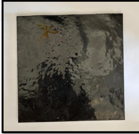
Şekil 3.4 : Line-x XS-100 poliüre tabaka
