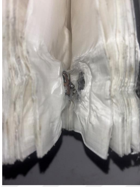
Şekil 4.34 : uhmwpe tabakalar arası delaminasyon
