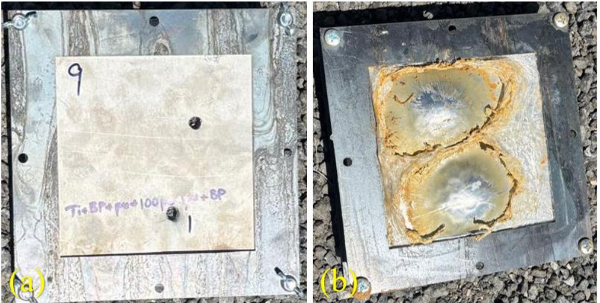
Şekil 4.37 : ti+bp+pu+100pe+pu+bp hedef numune hasar durumu (a) ön yüz, (b) arka yüz
