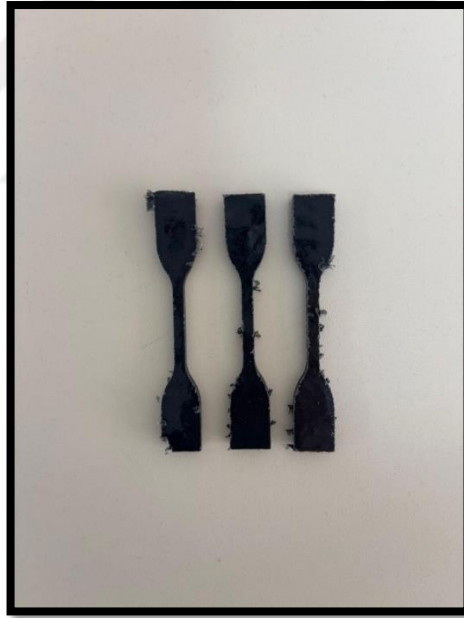
Şekil 3.19 : ASTM D638 Tip IV çekme numuneleri
