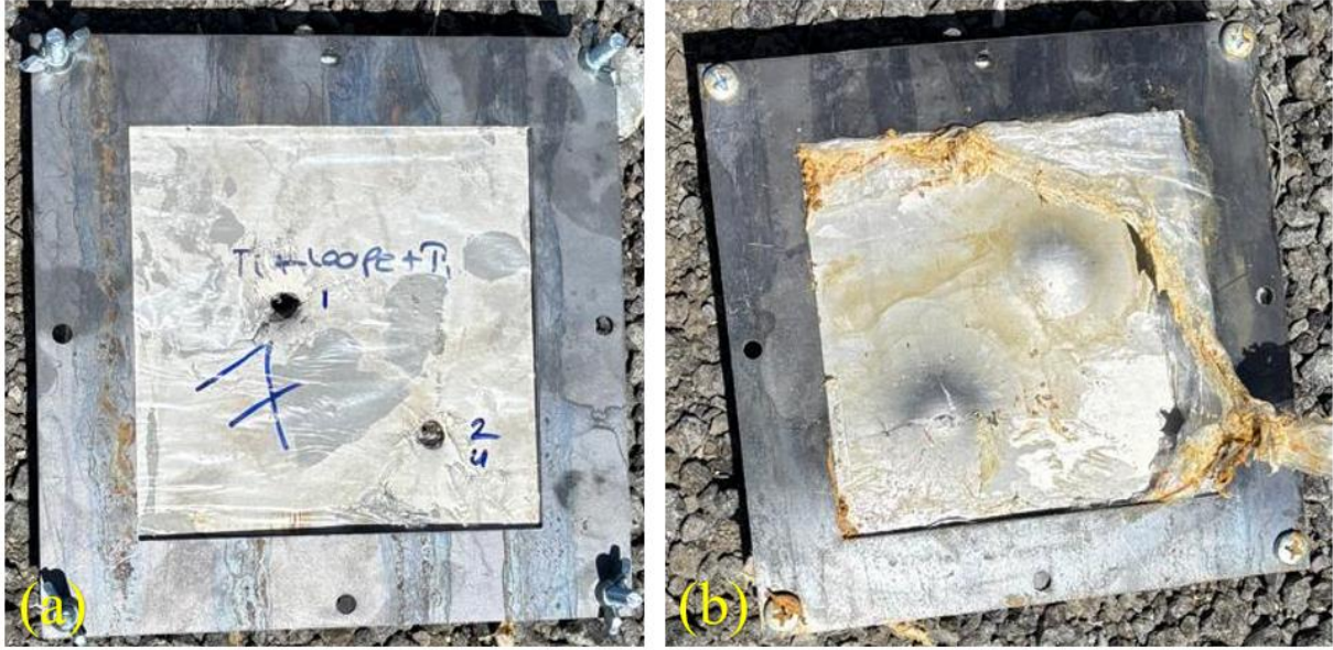
Şekil 4.32 : ti+100pe+ti hedef numune hasar durumu (a) ön yüz, (b) arka yüz
