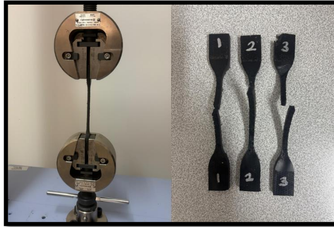
Şekil 3.21 : Çekme numunesi yerleşimi ve kopma sonrası görünümü
