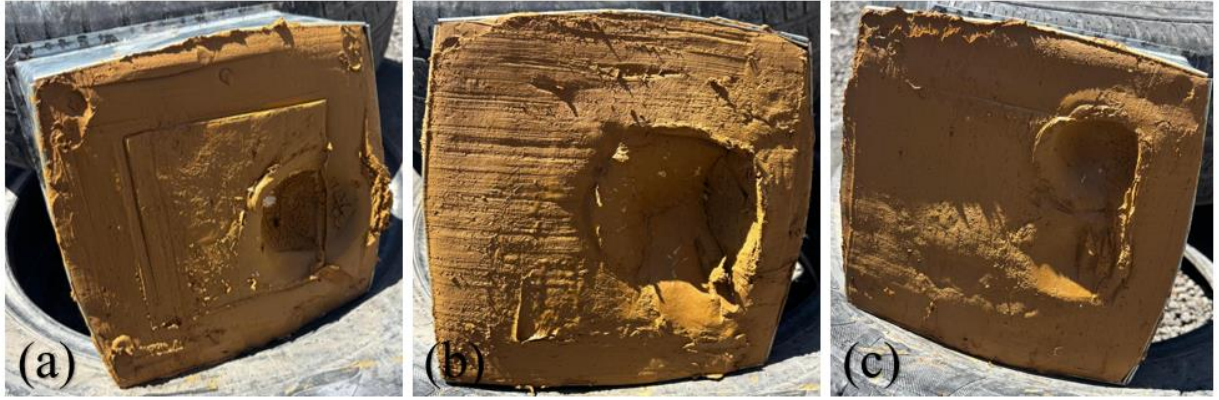
Şekil 4.27 : ti+pu+100pe+pu arka yüz çöküntü miktarları (a) 7,62x51 mm (1.atış), (b) 7,62x51 mm (2.atış), (c) 5,56x45 mm
