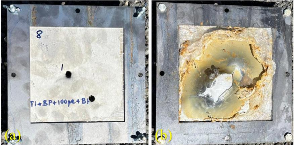
Şekil 4.35 : ti+bp+100pe+bp hedef numune hasar durumu (a) ön yüz, (b) arka yüz
