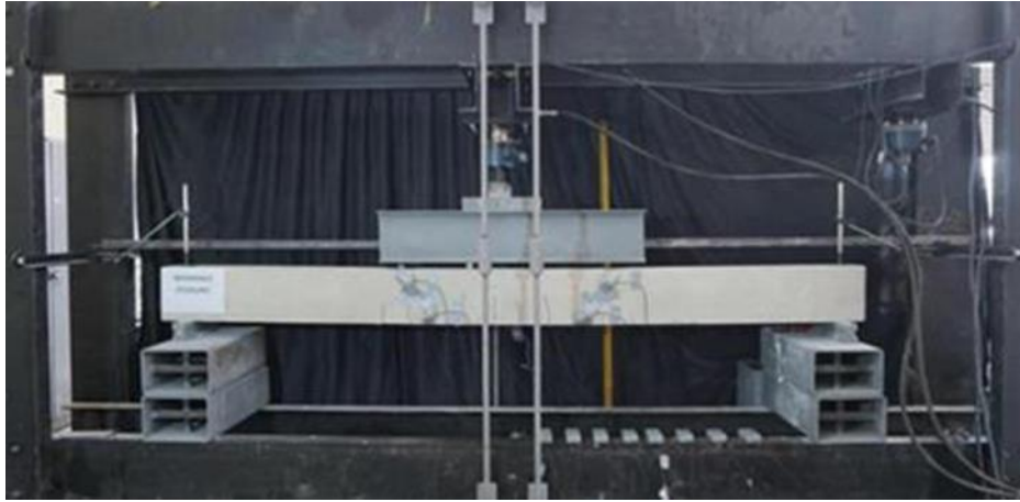
Şekil 4.3 Kirişte gelişen eğilme çatlakları (Kişisel arşiv, 2018)
