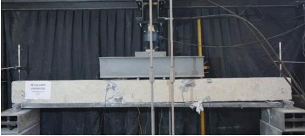
Şekil 4.28 Deney elemanın göçme şekli (Kişisel arşiv, 2018)
