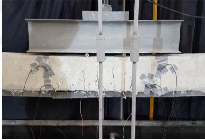
Şekil 4.23 Deney Elemanı 4'de laminede gelişen çatlak (Kişisel arşiv, 2018)
