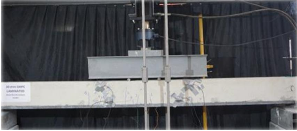
Şekil 4.15 Kirişte gelişen eğilme çatlakları (Kişisel arşiv, 2018)
