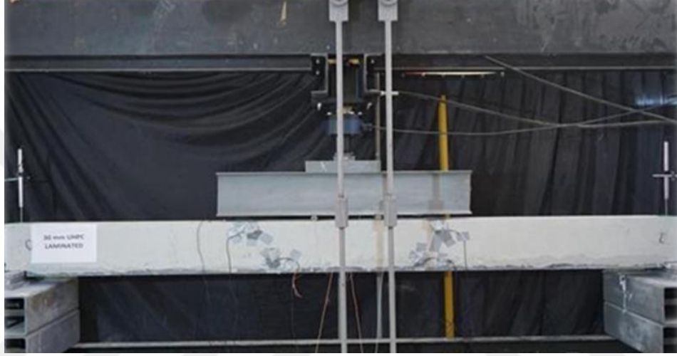
řekil 4.6 Deney Elemanı-2, 30 mm UYPB epoksi ile yapıřtırılmıř (Kiřisel arřiv, 2018)
