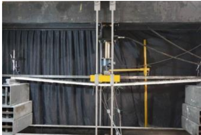
Şekil 2.35 Deney elemanının 91 mm deplasman yapmış görünümü(Kişisel arşiv, 2018)
