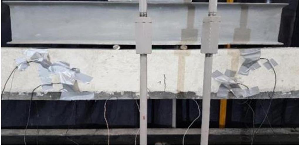
Şekil 4.21 İlk eğilme Çatlağı, Deney Elemanı 4 (Kişisel arşiv, 2018)
