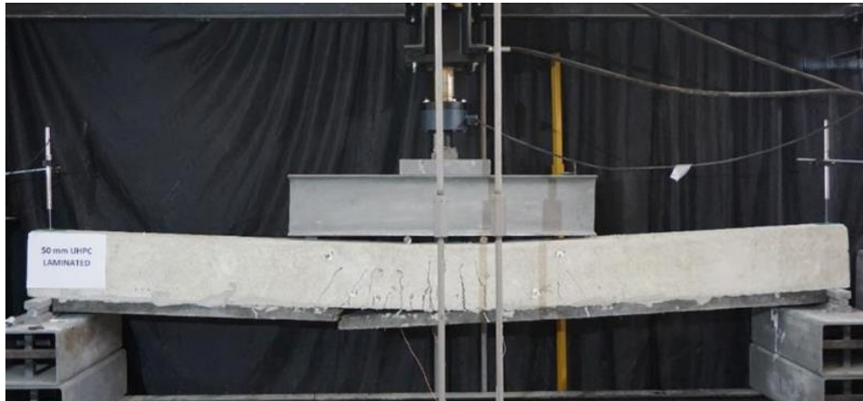
Şekil 4.25 Deney Elemanı 4 göçme şekli (Kişisel arşiv, 2018)
