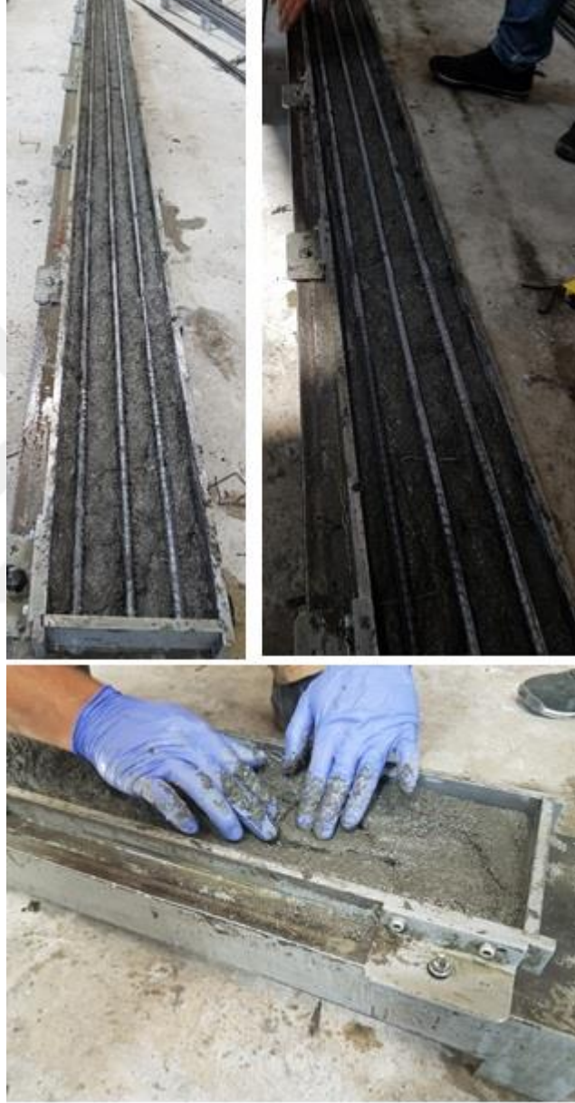
Şekil 2.31 İçerisinde Boyuna Donatı Bulunan UYPB Üretilmesi (Kişisel arşiv, 2018)
