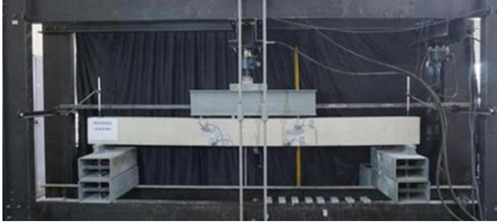
Şekil 4.2 İlk eğilme çatlağı, Deney Elemanı-1 (Kişisel arşiv, 2018)
