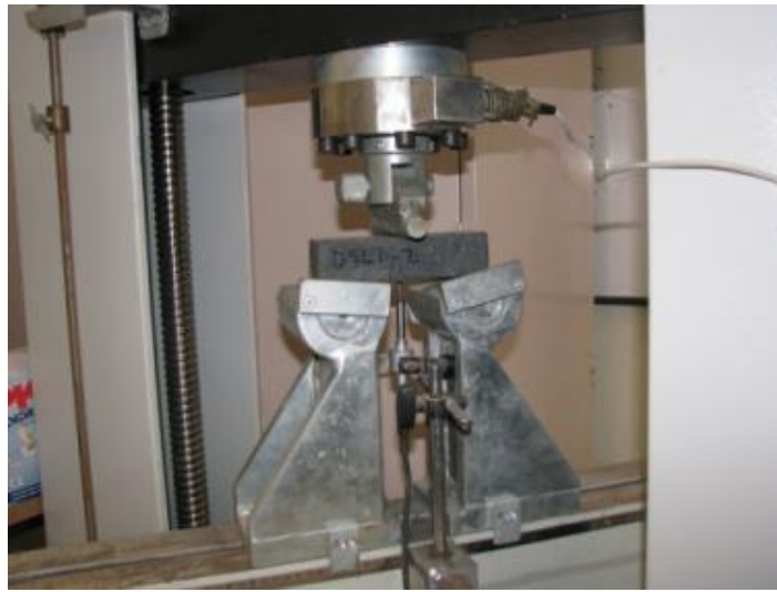
Şekil 2.6 Üç noktalı eğilme deney düzeneği (Kişisel arşiv, 2018)
