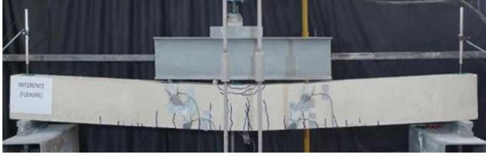
Şekil 4.4 Kirişte çatlaklarının son hali (Kişisel arşiv, 2018)
