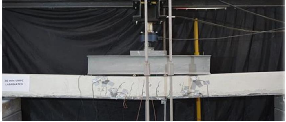
Şekil 4.10 Deney Elemanı-2 (5100 kN yük seviyesinde) (Kişisel arşiv, 2018)
