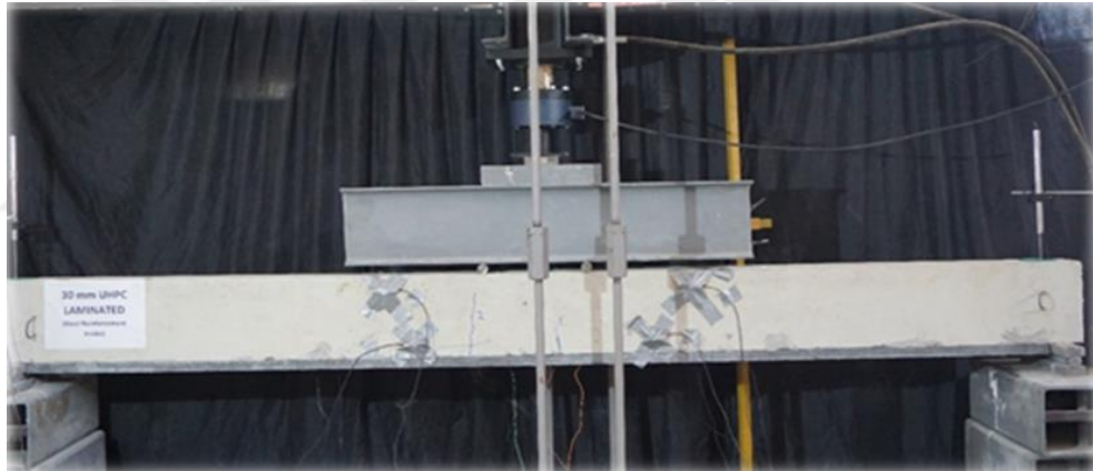
Şekil 4.14 Kirişte gelişen 1 ve 2 numaralı eğilme çatlakları (Kişisel arşiv, 2018)
