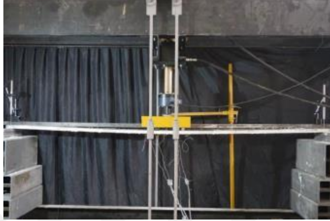
Şekil 2.34 Deney elemanının 30 mm deplasman hali (Kişisel arşiv, 2018)
