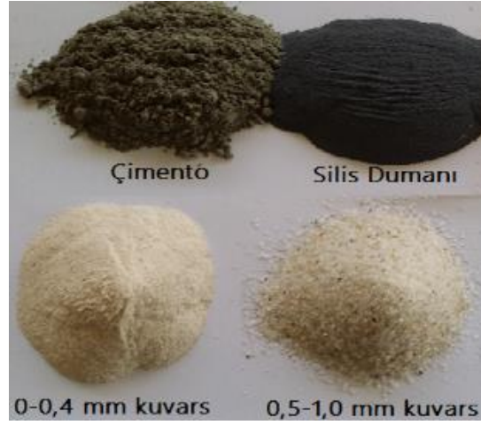
Şekil 2.2 Çalışmada kullanılan bağlayıcı maddeler ve agregalar(Kişisel arşiv, 2018)
