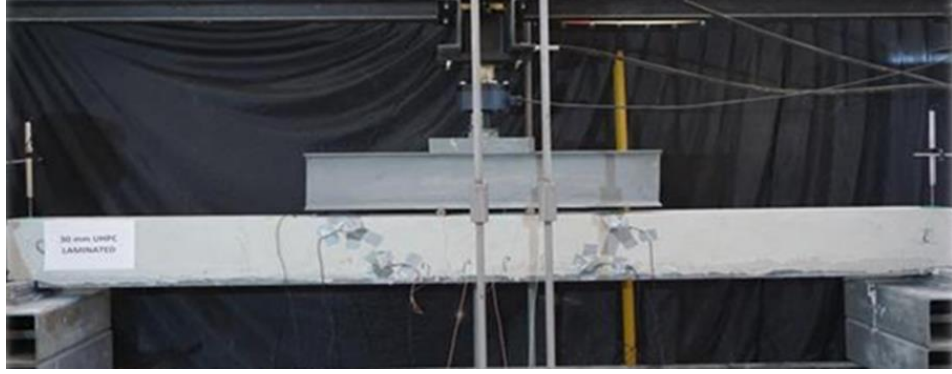
Şekil 4.8 Kirişte gelişen eğilme çatlakları(Kişisel arşiv, 2018)
