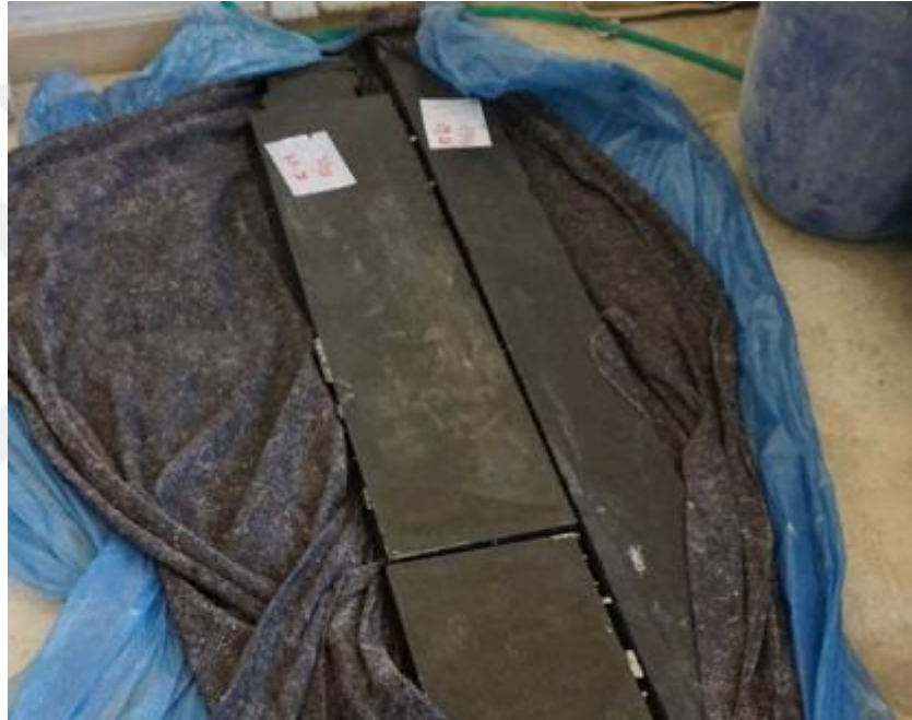
Şekil 2.30 Laminelerin ıslak örtü ve naylon örtölerek kür edilmesi (Kişisel arşiv, 2018)
