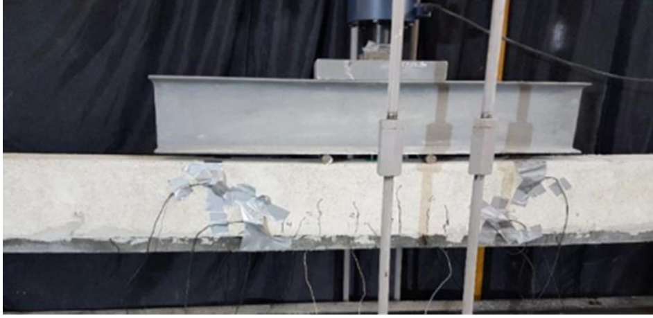
Şekil 4.22 Deney Elemanı 4'de gelişen eğilme çatlakları (Kişisel arşiv, 2018)
