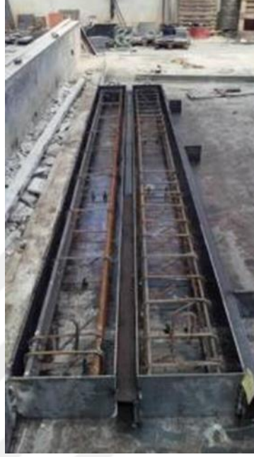
Şekil 3.5 Beton dökümüne hazır deney elemanları (Kişisel arşiv, 2018)
