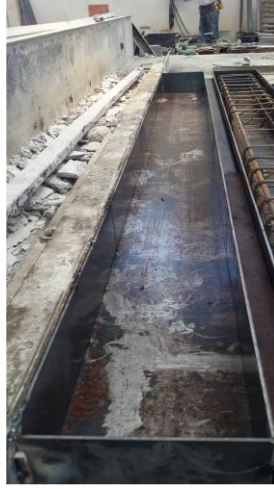
Şekil 3.3 Çelik kalıp kesit detayı (Kişisel arşiv, 2018)
