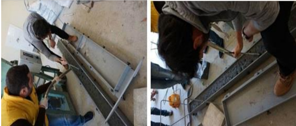
Şekil 2.29 Taze UYPB'nin şiş ve vibrasyon ile yerleştirilmesi (Kişisel arşiv, 2018)
