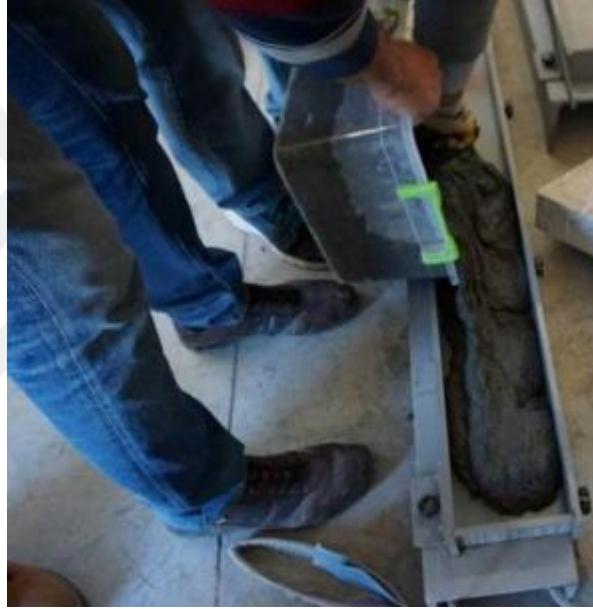
Şekil 2.28 Taze UYPB'nin kalıba dökülmesi (Kişisel arşiv, 2018)
