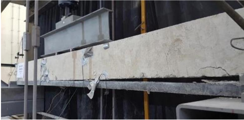
Şekil 4.29 Deney elemanın göçme şekli (Kişisel arşiv, 2018)
