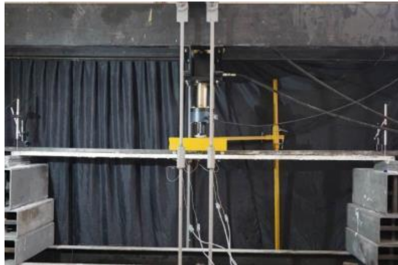
Şekil 2.33 30 mm kalınlığında lamine deneyi (Kişisel arşiv, 2018)
