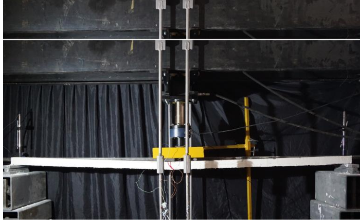
Şekil 2.48 Lamine'nin maksimum deplasman halinde çekilmiş fotoğrafı (Kişisel arşiv, 2018)
