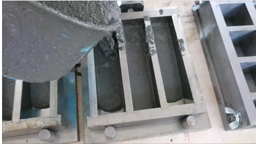
Şekil 2.7 40x40x160 mm kalıpların doldurulması (Kişisel arşiv, 2016)
