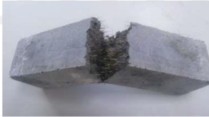
Şekil 3.16 %2 oranında 13 mm Lif içeren numunenin deney sonrası görüntüsü (Kişisel arşiv, 2016)
