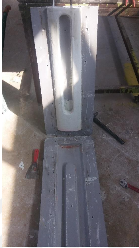
Şekil 4.7 Polyester kalıp ile hazırlanan numune (Kişisel arşiv, 2017)
