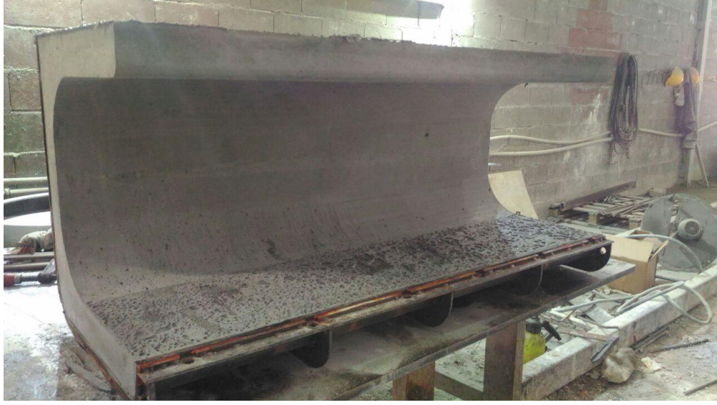
Şekil 5.15 Yeni bank kalıptan sökme aşaması (Kişisel arşiv, 2016)
