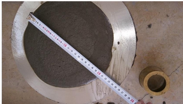
Şekil 3.4 Agregası hacmi %55 olan karışımın yayılma değeri (Kişisel arşiv, 2016)
