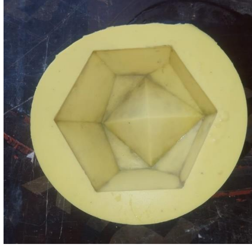
Şekil 4.21 PLA'dan alınan poliüretan kalıp (Kişisel arşiv, 2019)
