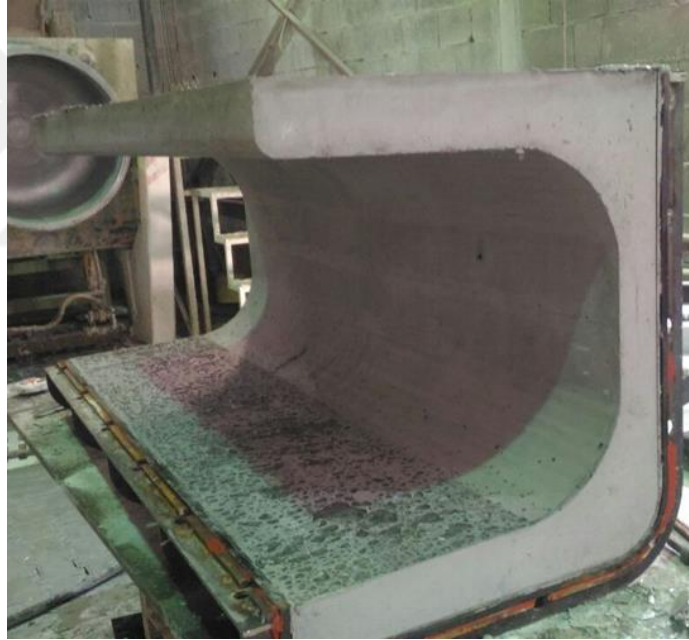
Şekil 5.16 Yeni bank kalıptan sökme aşaması (Kişisel arşiv, 2016)
