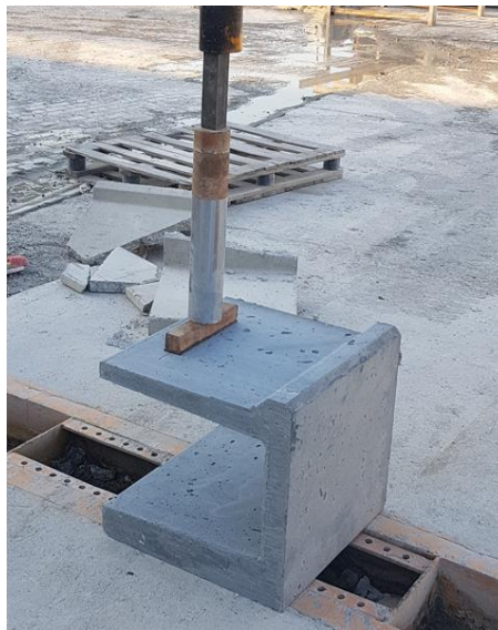
Şekil 5.8 Bank Prototip 1 yükleme deneyi (Kişisel arşiv, 2016)
