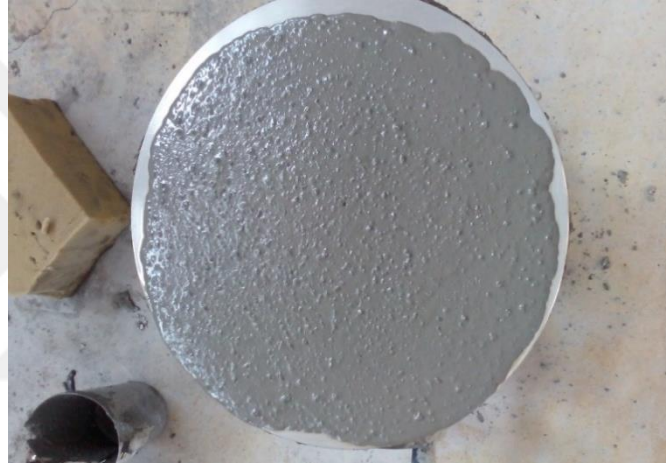
Şekil 3.3 Agregası hacmi %40 olan karışımın yayılma değeri (Kişisel arşiv, 2016)
