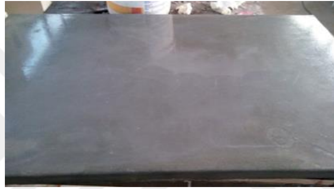
Şekil 4.11 Beton yüzeyinde şeffaf epoksi denemesi (Kişisel arşiv, 2017)
