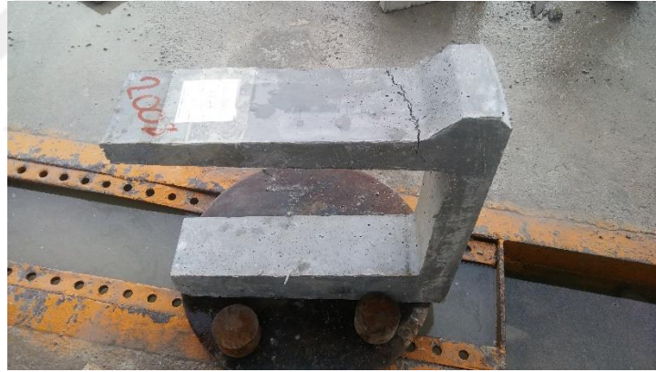
Şekil 5.11 2004 nolu karışım ve %2 lifle hazırlanan prototip (Kişisel arşiv, 2016)
