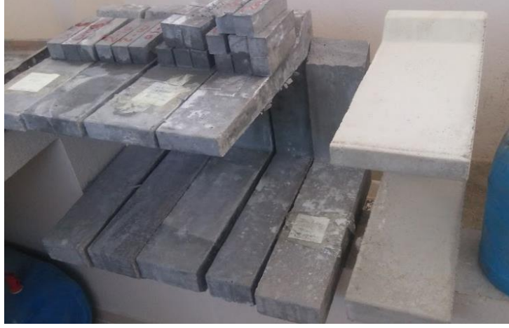
Şekil 5.7 Prototip-1 bank kalıbından üretilmiş numuneler (Kişisel arşiv, 2016)
