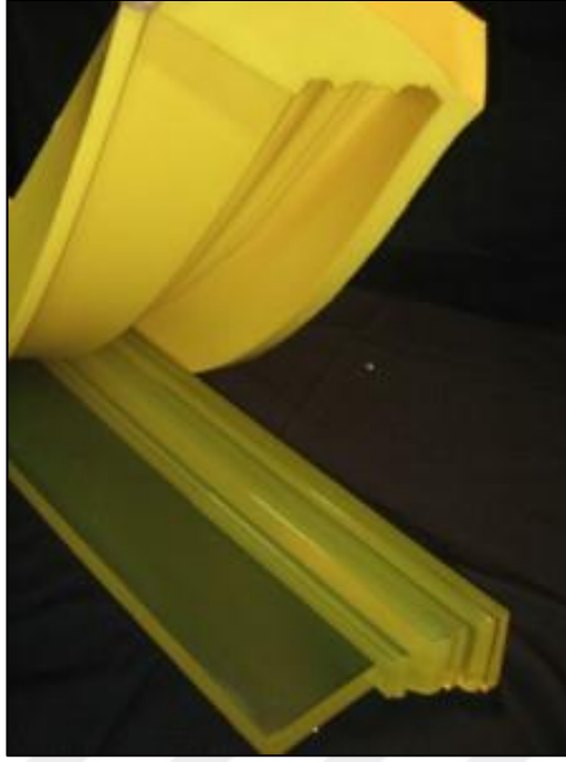
Şekil 2.2 Shore A45 poliüretan kalıp (Polytek, b.t)
