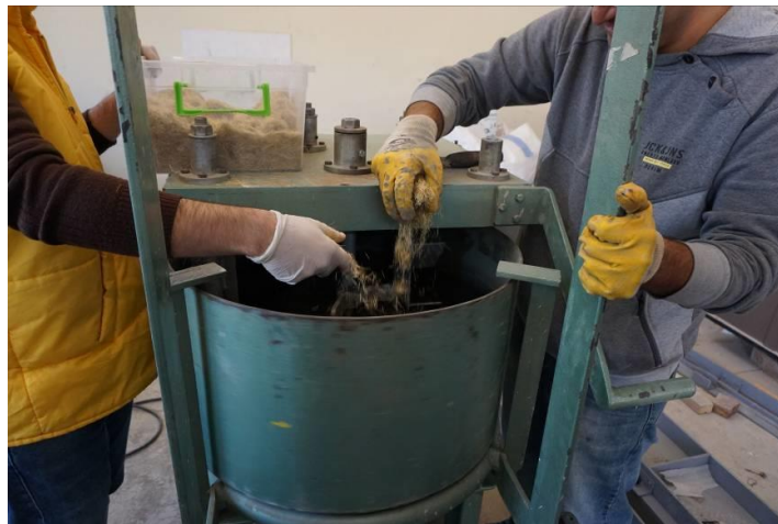
Şekil 2.17 Çelik mikro liflerin serpiştirilerek karışıma eklenmesi (Kişisel arşiv, 2016)
