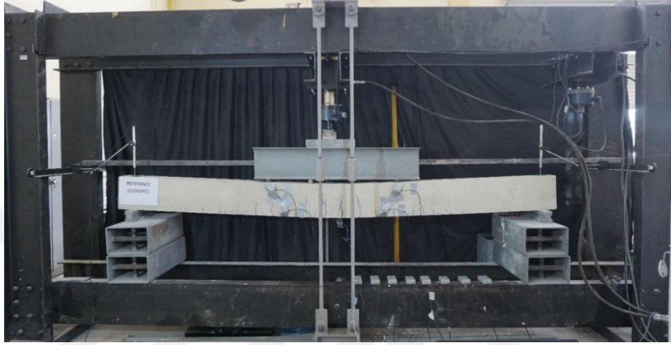
Şekil 4.4 Kiriş-1 çatlaklarının son hali (Kişisel arşiv, 2017)
