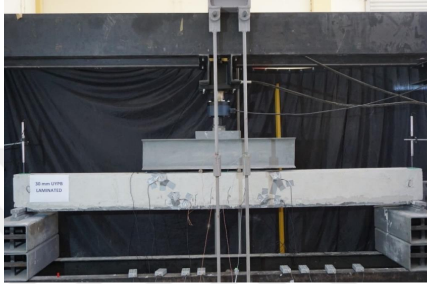
Şekil 4.9 Kiriş-2 çatlak oluşumu (Kişisel arşiv, 2017)
