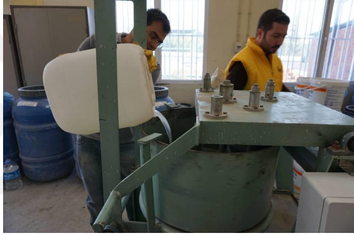
Şekil 2.16 Bağlayıcılara su+akışkanlaştırıcı çözeltisinin ilavesi (Kişisel arşiv, 2016)
