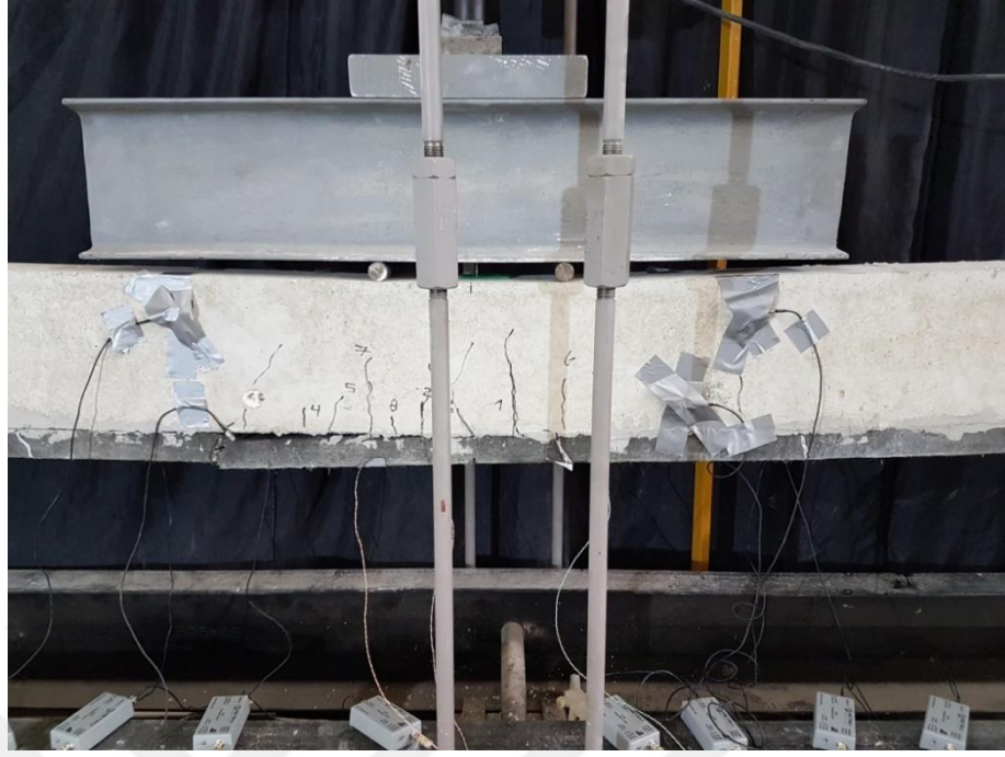
Şekil 4.18 Kiriş-3 çatlak oluşumu (Kişisel arşiv, 2017)
