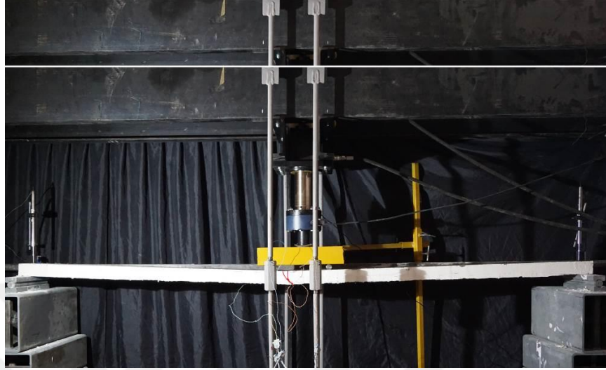
Şekil 3.16 Plakanın maksimum deplasman halinde çekilmiş fotoğrafı (Kişisel arşiv, 2016)
