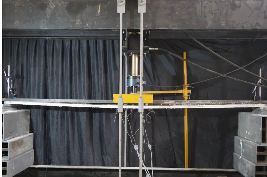
Şekil 3.2 Deney elemanının 30 mm deplasman hali (Kişisel arşiv, 2016)
