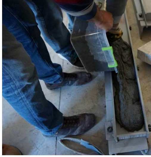
Şekil 2.19 Taze UYPB'nin kalıba dökülmesi (Kişisel arşiv, 2016)
