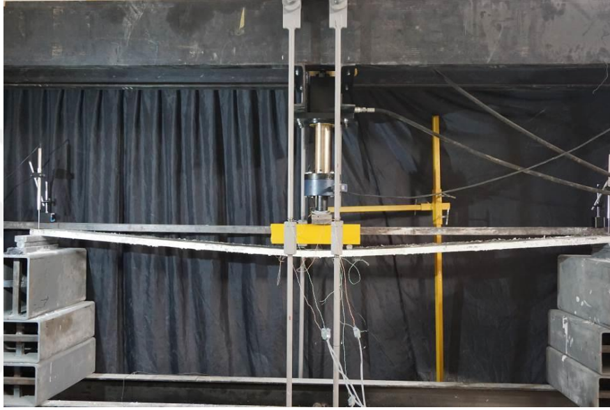
Şekil 3.3 Deney elemanının 91 mm deplasman yapmış görünümü (Kişisel arşiv, 2016)
