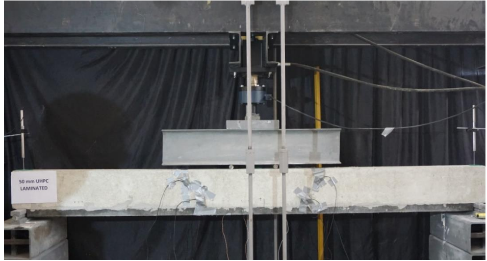
Şekil 4.16 İlk eĝilme çatlaĝı (Kiřisel arřiv, 2017)
