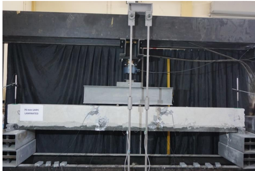
Şekil 4.24 70mm kalınlığa sahip UYPB ile güçlendirilmiş deney elemanı (Kişisel arşiv, 2017)
