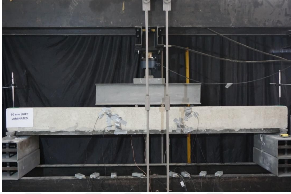
Şekil 4.15 50mm kalınlıĝa sahip UYPB ile gçlendirilmiř deney elemanı (Kiřisel arřiv, 2017)
