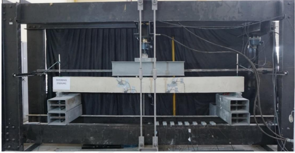
Şekil 4.2 İlk eğilme çatlakları (Kişisel arşiv, 2017)
