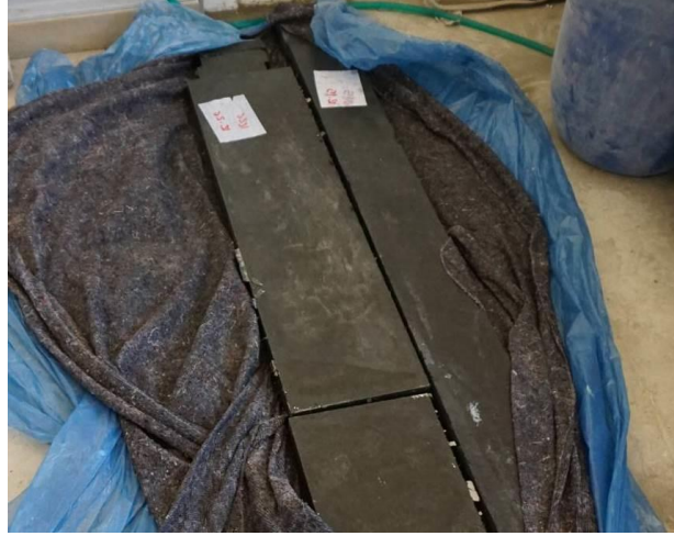
Şekil 2.21 Plakaların ıslak örtü ve naylon örtülerek kür edilmesi (Kişisel arşiv, 2016)
