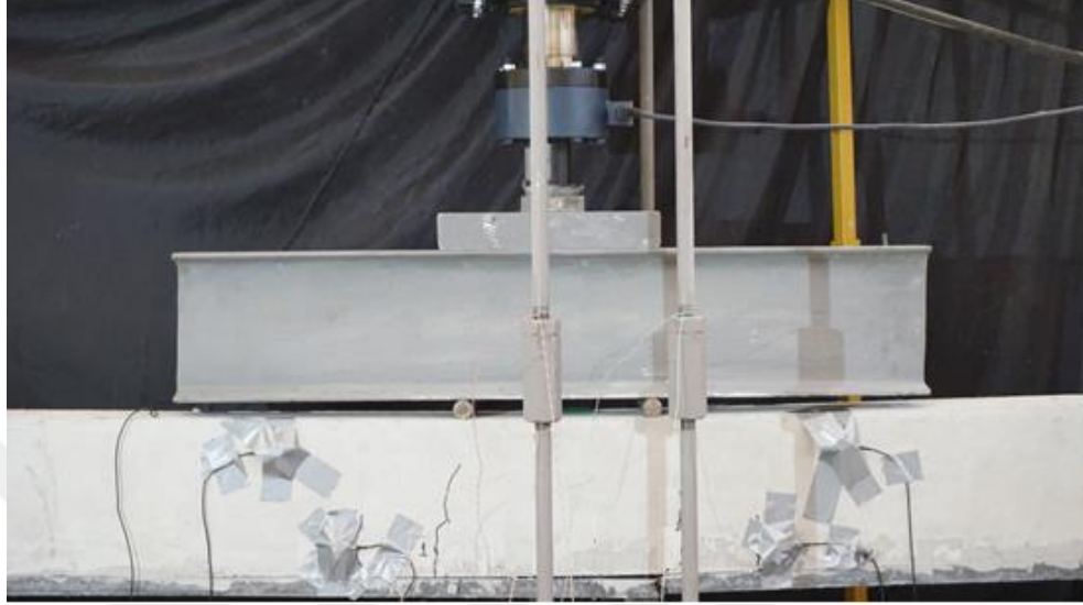
Şekil 4.7 İlk eğilme çatlağı (Kişisel arşiv, 2017)
