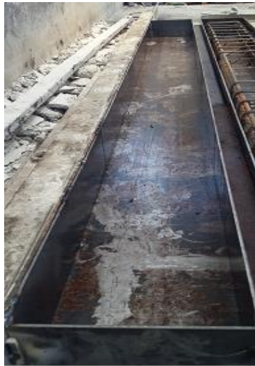
Şekil 2.6 Çelik kalıp kesit detayı (Kişisel arşiv, 2016)
