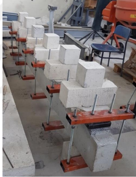
Şekil 2.28 UYPB plaka ile betonarme kirişin üzerine yük (Kişisel arşiv, 2016)
