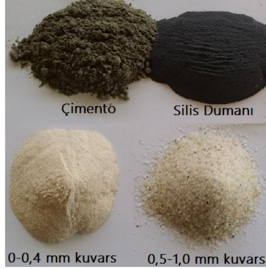
Şekil 2.2 Çalışmada kullanılan bağlayıcı maddeler ve agregalar (Kişisel arşiv, 2016)
