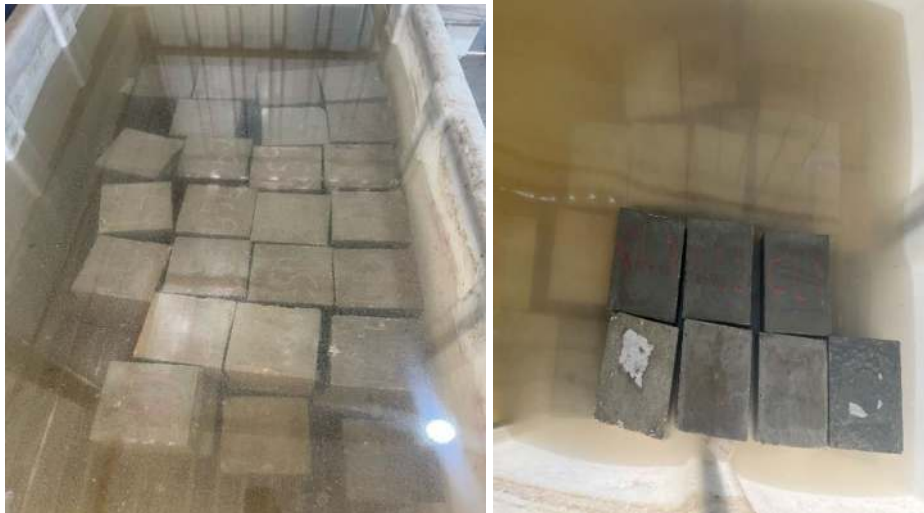
Şekil 4.16 Kür havuzuna bırakılan numuneler
