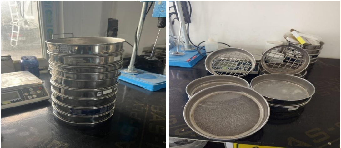
Şekil 4.5 Agregâ elek deneyi
