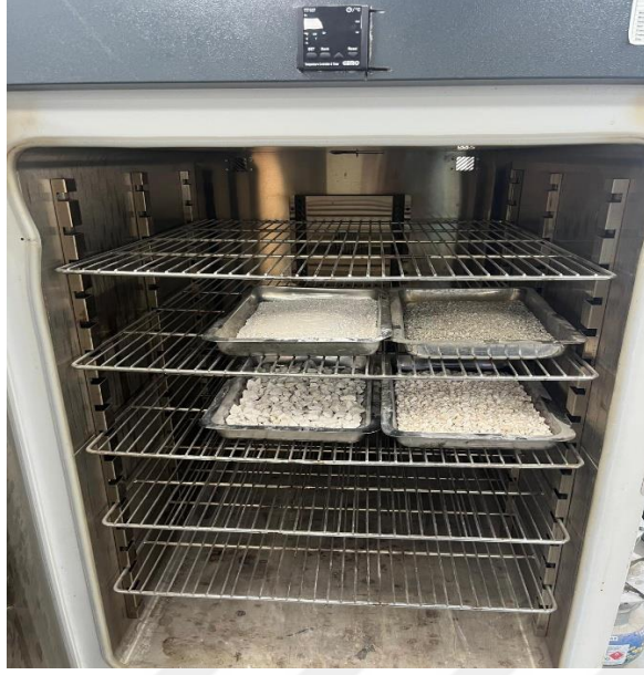
Şekil 4.4 Etüvde kurutulan agregâ numuneleri
