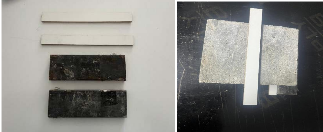
Şekil 4.18 Yarmada çekme deneyi için kullanılan sıkıştırma şeridi ve çelik yükleme parçaları
