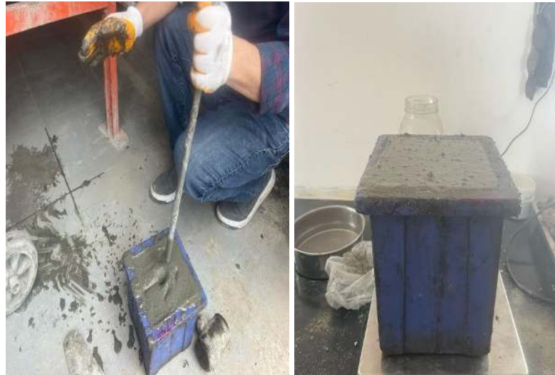
Şekil 4.14 UYPB küp numunelere yerleşimi
