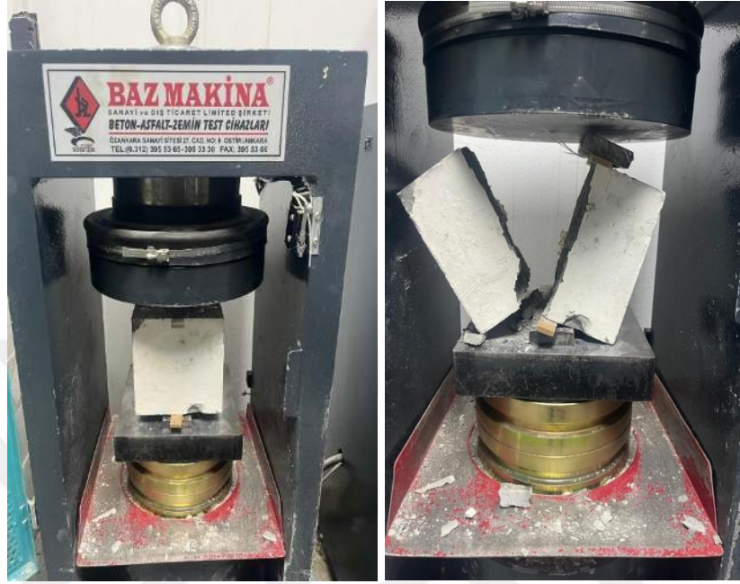
Şekil 4.19 Yarmada çekme deneyi
