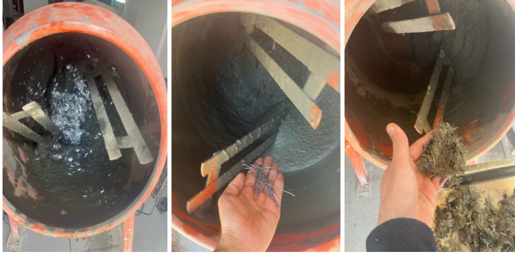
Şekil 4.13 LK-UYPB farklı hacimsel oranlarda üretimi
