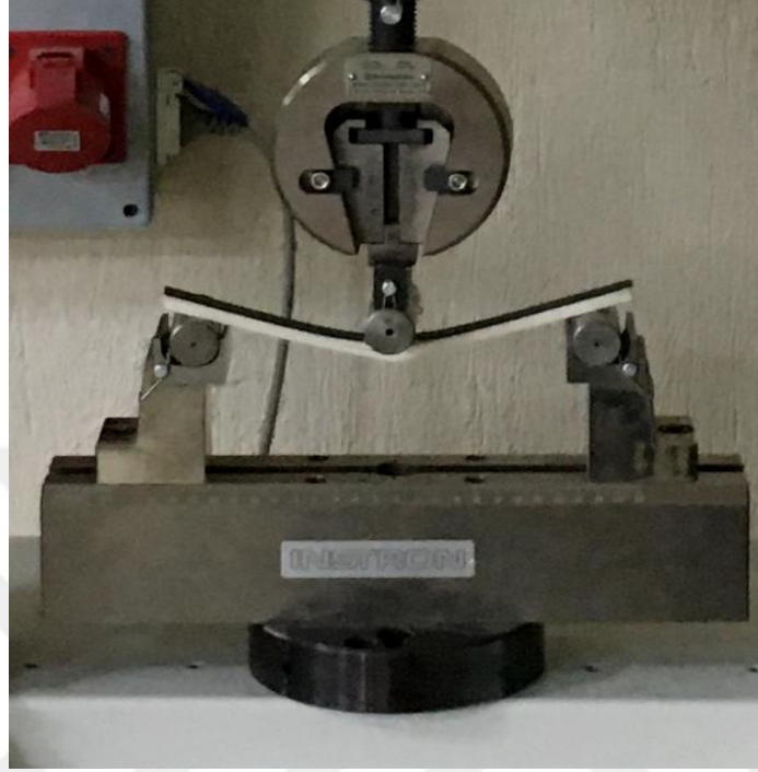
Resim 4.10 UHMW-PE ve ERKFP içeren numunenin üç nokta eğme testi.
