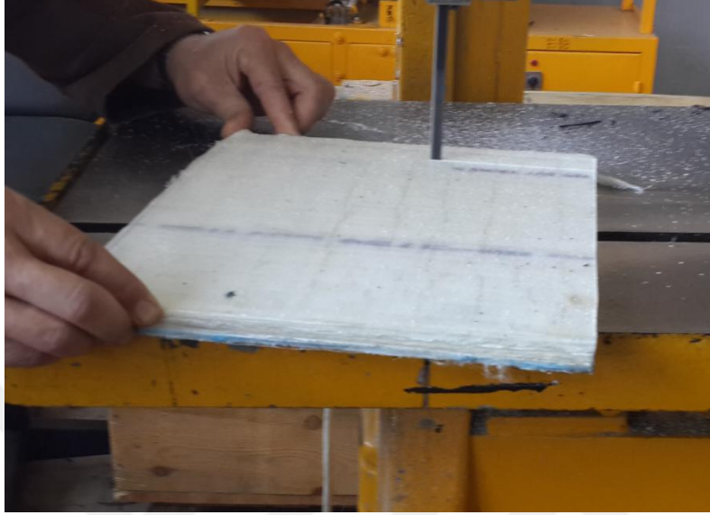
Resim 3.5 Şerit testere ile zırhların kenar temizliği.
