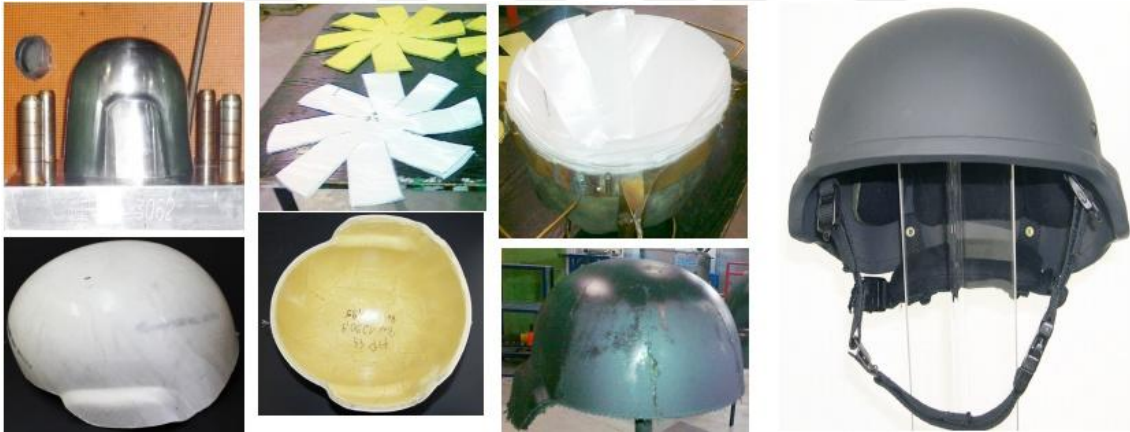
Resim 1.2. Balistik hibrit kask retiminin adımlarını gsteren fotođraf (Fejdys vd. 2015).
