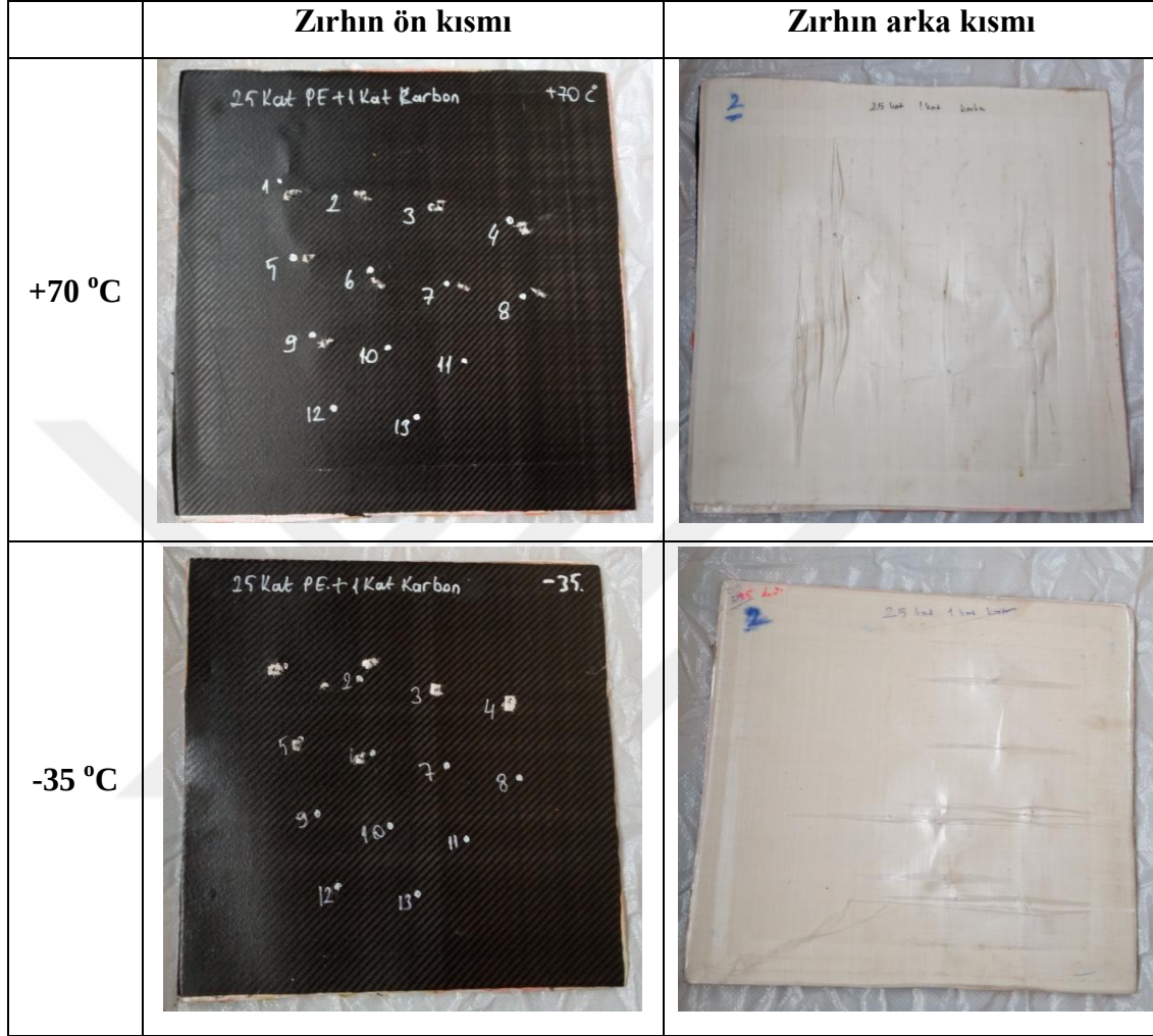
Resim 4.7 25 kat UHMW-PE ve 1 kat ERKFP zırhın balistik test sonrası görüntüleri.
