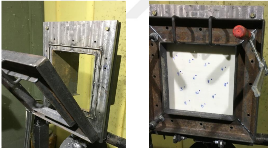
Resim 4.2 Test malzemesinin sabitlenmesi.
