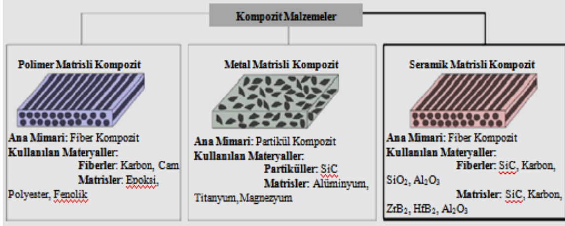
Şekil 2.8 Kompozit malzemelerin matris özelliklerine göre sınıflandırılması (Diaz 2019).
