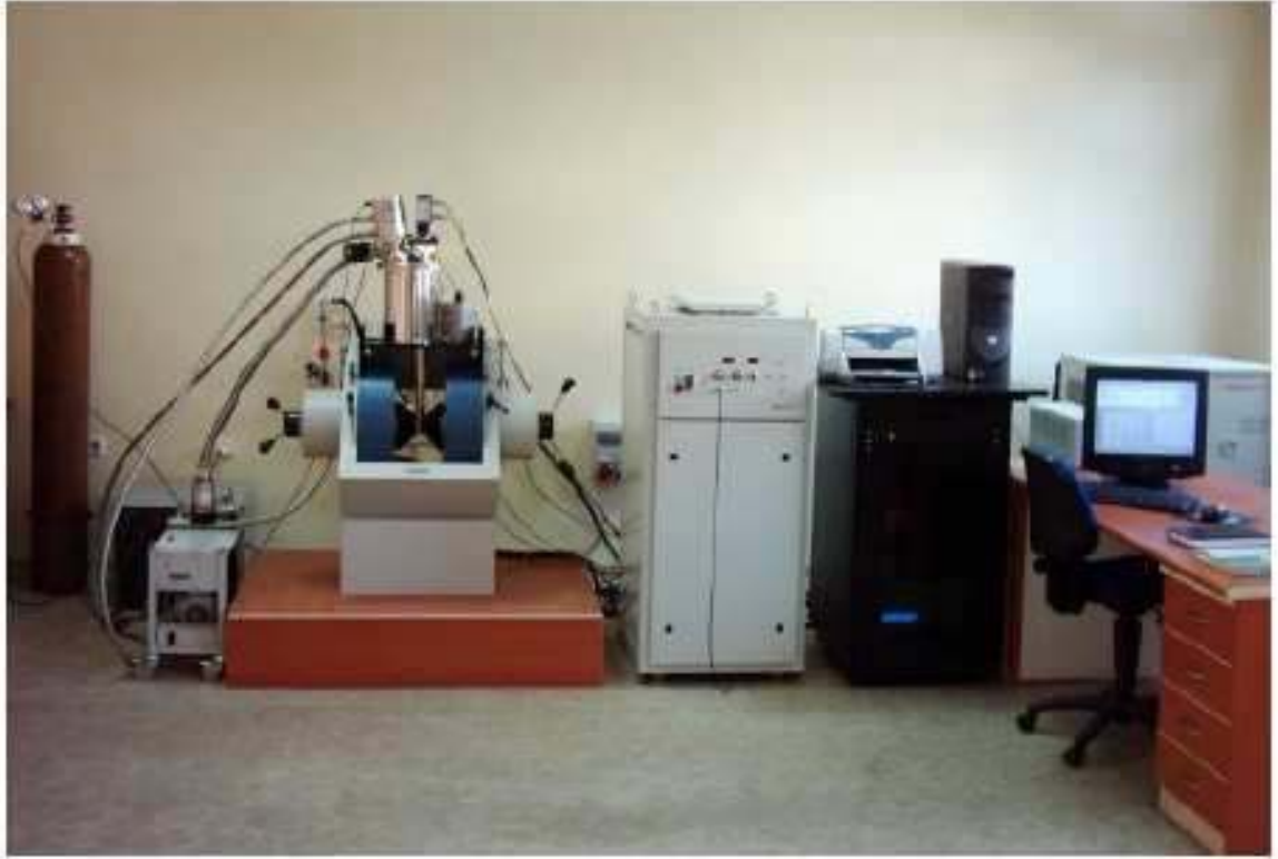
Resim 5.2. Lakeshore 7700 serisi Yüksek Empedans Hall etkisi ölçüm sistemi
