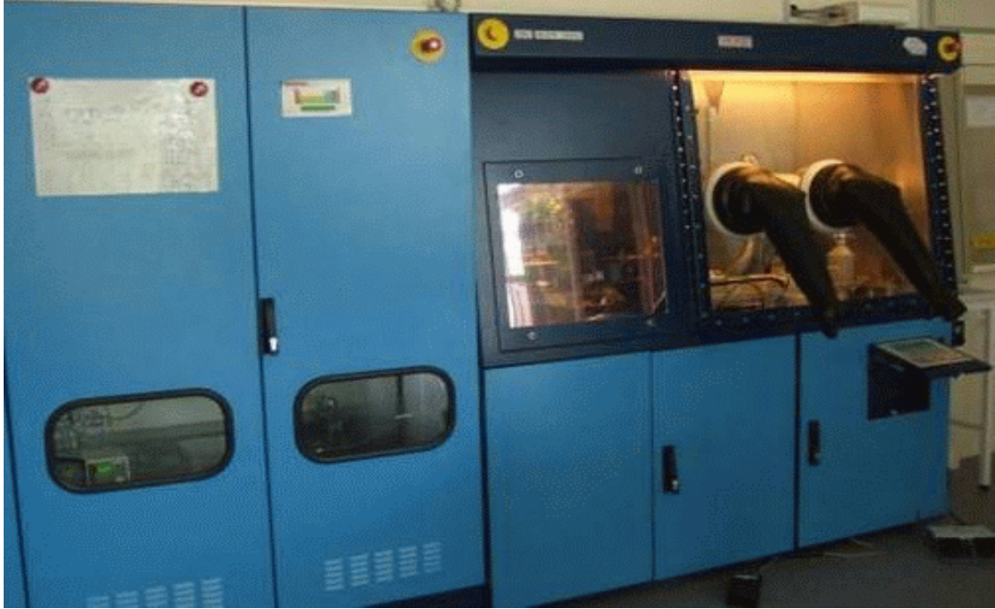
Resim 5.1. Bilkent Üniversitesi Nanoteknoloji Araştırma Merkezinde bulunan AIXTRON RF200/4 RF-S MOCVD sistemi
