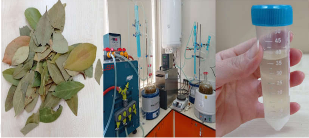
Şekil 13. Buhar distilasyonu ile defne esansiyel yağı elde edilmesi
