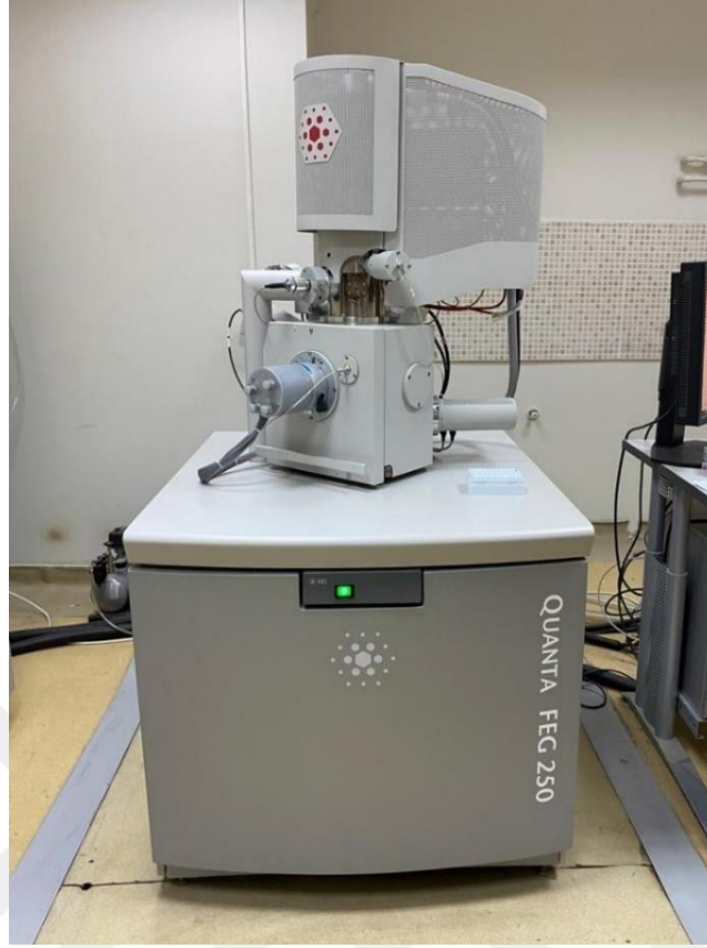
Resim 14. Çalışmada kullanılan SEM cihazı
