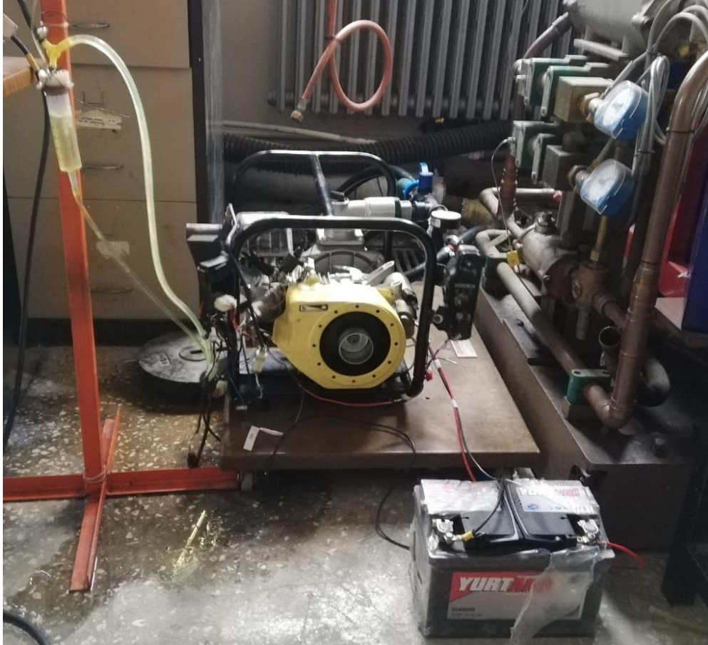
Şekil 2.23. Enjektörlü yakıt sisteminin deney düzeneği
