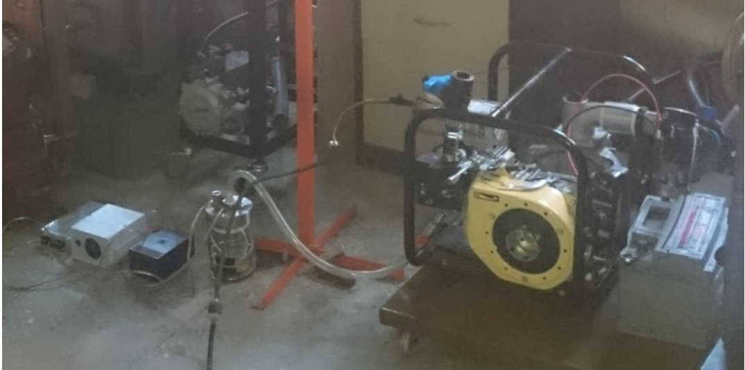
Şekil 2.22 Ultrasonik yakıt sisteminin deney düzeneği
