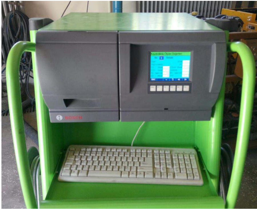
Şekil 53. Bosch BEA 350 egzoz emisyon analiz cihazı
