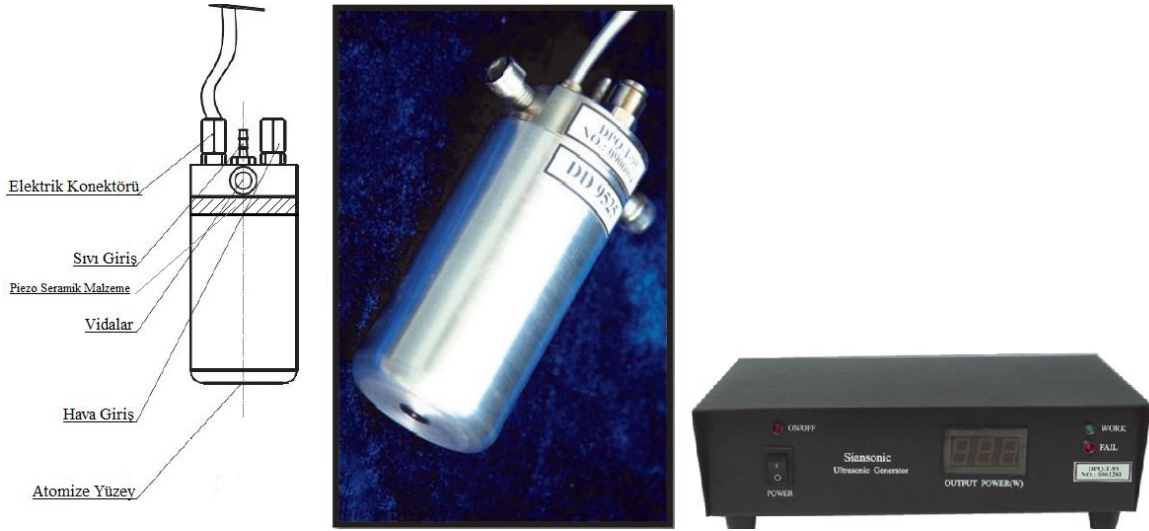
Şekil 1.44. Ultrasonik enjektör şeması, Ultrasonik enjektör, Ultrasonik jeneratör.
