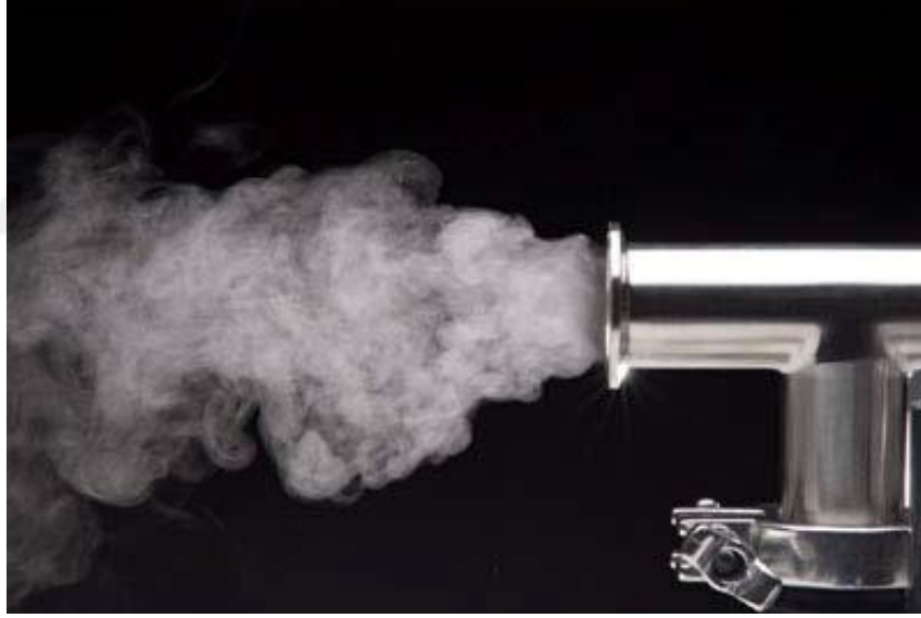
Şekil 1.46. Ultrasonik spreyleme ile oluşan yağ tanecik bulutu
