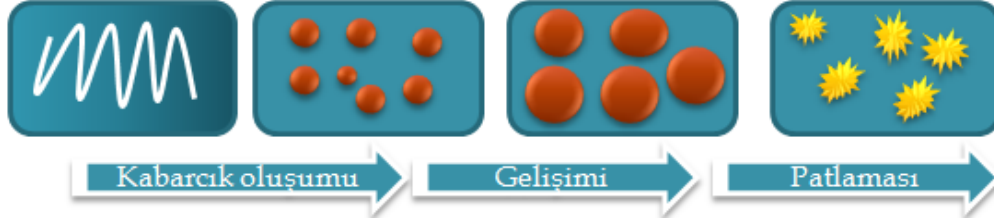
Şekil 2.2: Ultrason etkisi ile sıvı içinde kabarcıkların oluşum, gelişim ve patlama süreci
