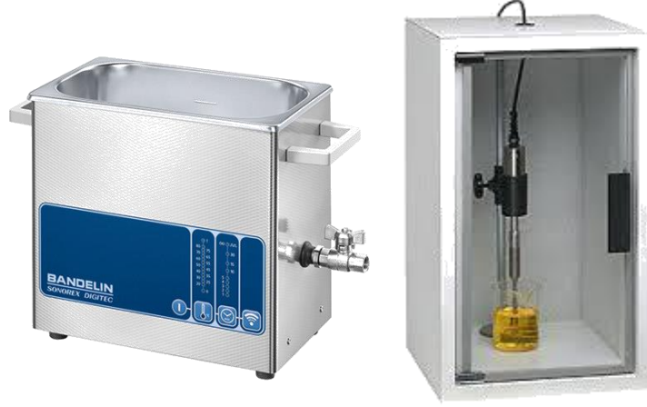
Şekil 2.4: Ultrasonik su banyosu (solda) ve ultrasonik prob (sağda)
