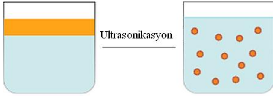
Şekil 2.9. Ultrasonikasyonun Yağ Homojenizasyona Etkisi (Chemat ve ark., 2011)
