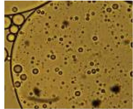
Ultrasonikasyon Uygulaması İle Emülsiyon Uygulamasında Yağ Moleküllerinin Dağılımı
