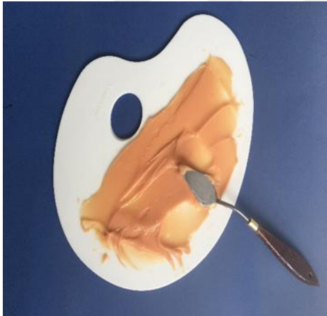
Resim 3.5. Temiz yüzey üzerinde silikon materyalinin karıştırılması
