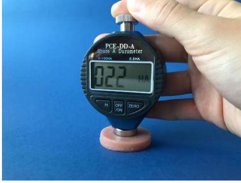
Resim 3.8. PCE DD-A Shore A Durometer cihazı (PCE Instruments, GmbH, Almanya)
