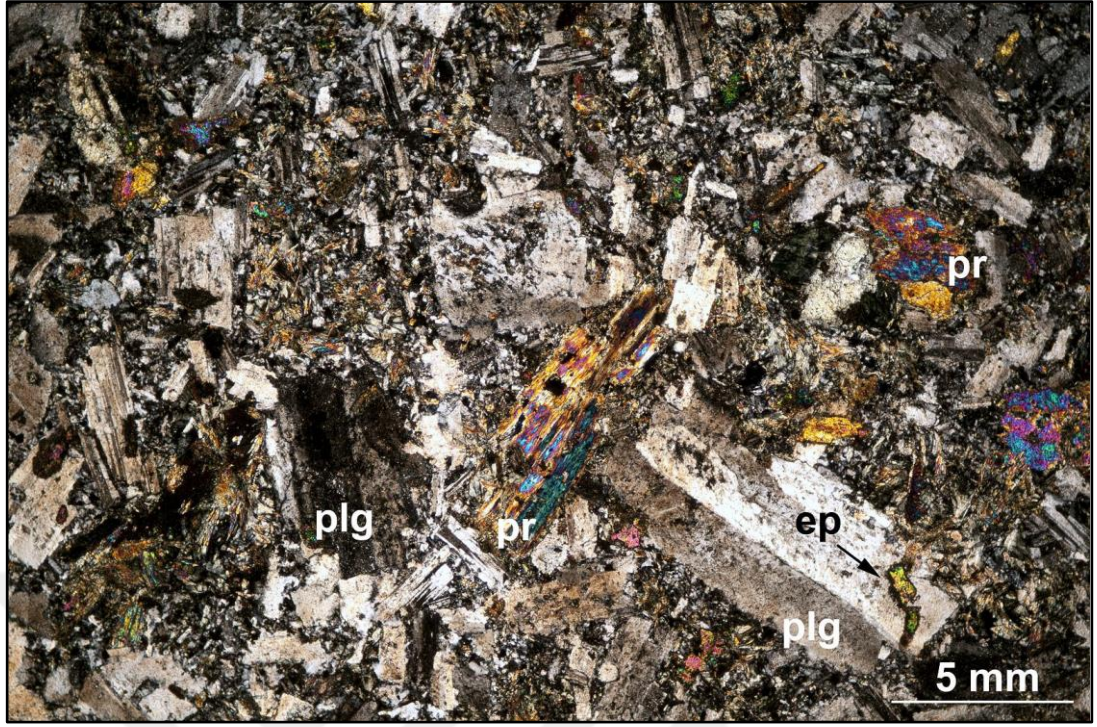
Şekil 2.16 Esendemir Tepe bölgesi diyorit kayacı ince kesiti (çift nikol); albitleşmiş plajiolklas feldispat, kalıntı piroksen ve çatlak dolgusu şeklinde epidot (plg: plajiolklas feldispat, pr: piroksen, ep: epidot)
