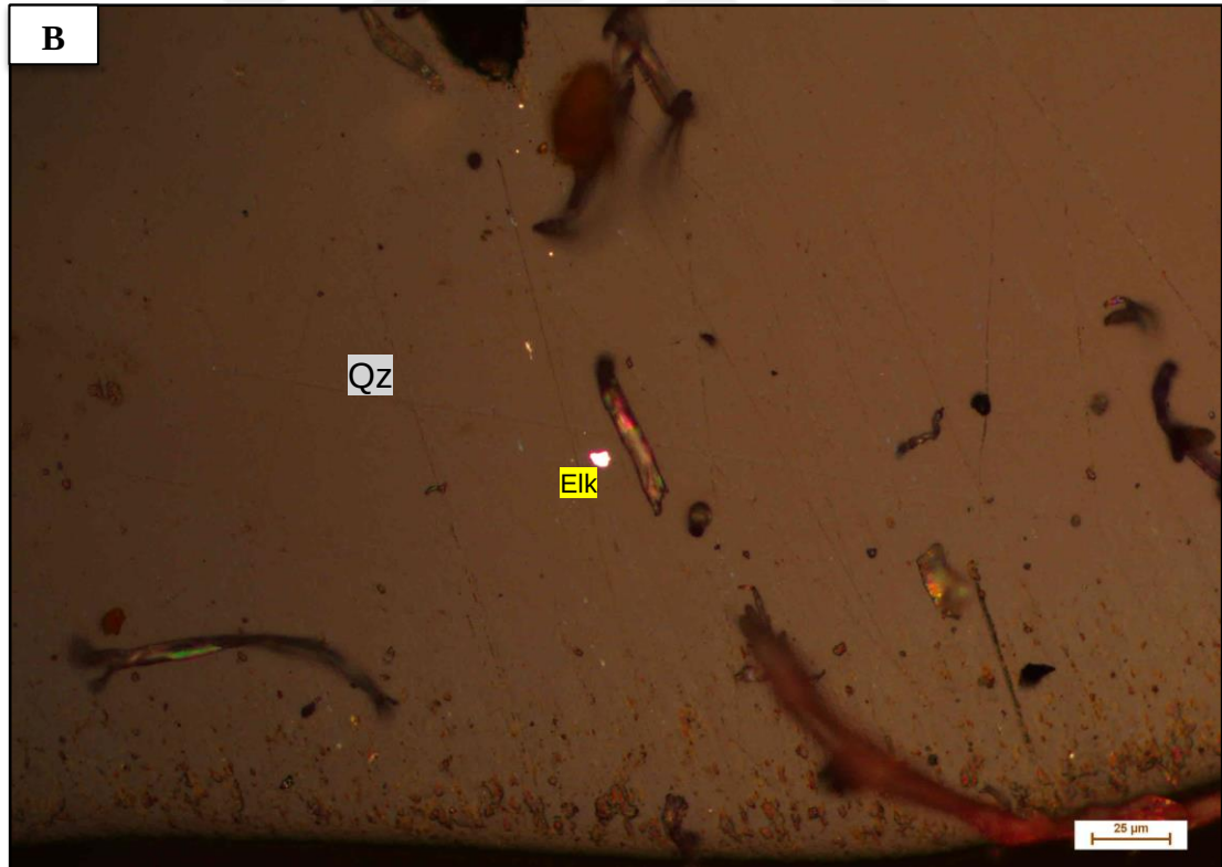
Şekil 5.19 S_8 nolu örneğe ait //N mikroskop fotoğrafları: Go: Götüt, HFO: Sulu Hidroksit, Qz: Kuvars, Elk: elektrum
