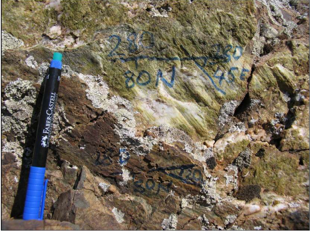
Şekil 18. Normal bileşene sahip doğrultu atımlı fay düzlemi (Cevizdere Köyü doğusu)
