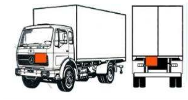
Şekil 3.28 : Sadece ambalajlı taşıma yapan araç işaretleme.
