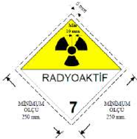
Şekil 3.18 : Sınıf 7'ye ait radyoaktif malzeme levhası.
