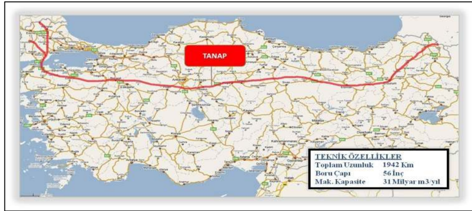
Şekil 64: Trans Anadolu Doğal Gaz Boru Hattı (TANAP) Projesi
