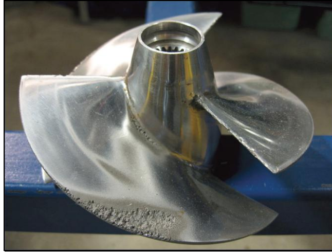
Şekil 2. 17 Bir pervanede kavitasyonun neden olduğu erozyon örneği[23]
