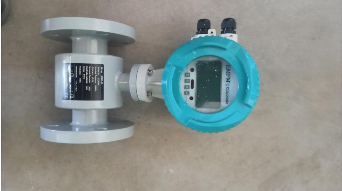
Şekil 5.7 Laboratuvarında bulunan ve debi ölçümünde kullanılan elektromanyetik debimetre (Kişisel arşiv, 2022)
