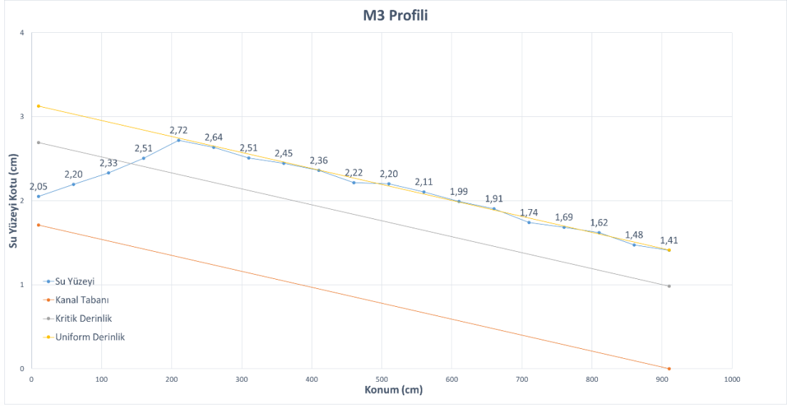
Şekil 6.10 Deneyssel olarak oluşturulan 1 numaralı M3 profilinin boy kesitsel gösterimi
