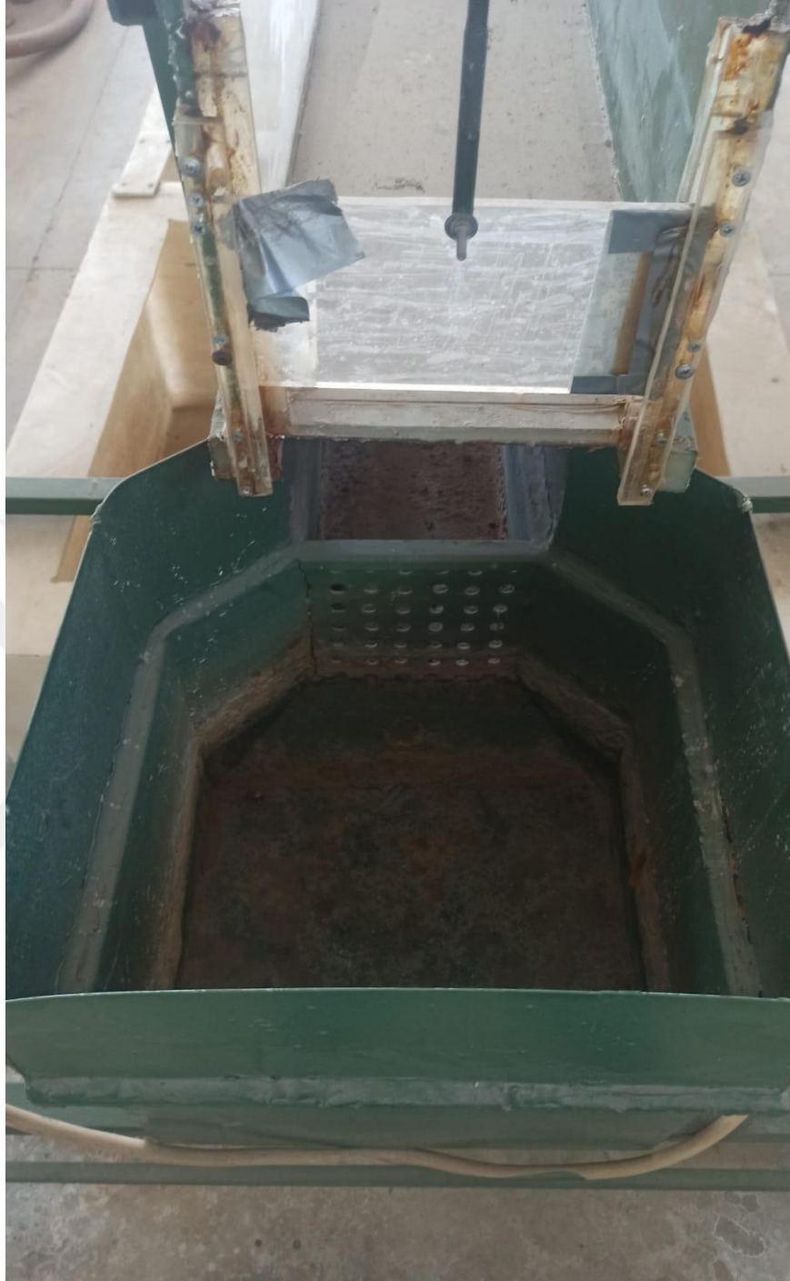
Şekil 5.8 Deney düzeneğinin mansap kısmında bulunan ve düşey yönde hareket edebilen eşik
