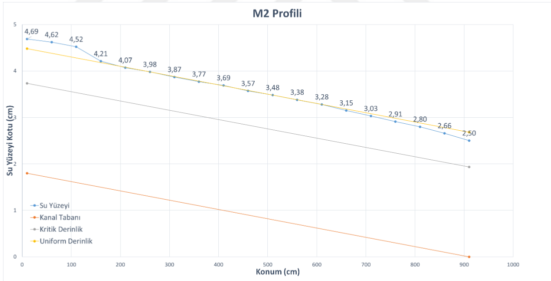
Şekil 6.5 Deneysel olarak oluşturulan 2 numaralı M2 profilinin boy kesitsel gösterimi
