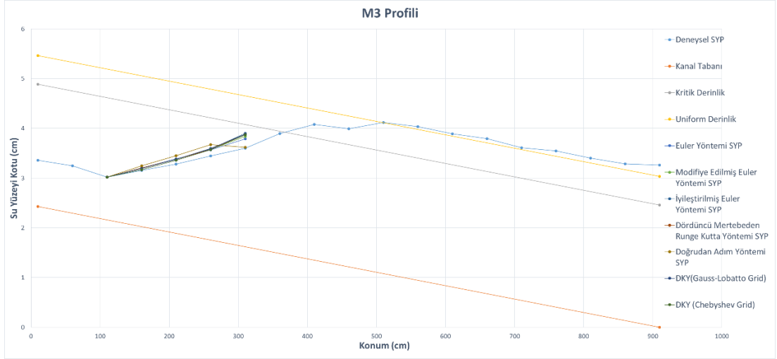
Şekil 6.49 5 numaralı M3 profiline ait deneysel ve sayısal çözümlerden elde edilmiş su yüzeyi profillerinin karşılaştırmalı gösterimi
