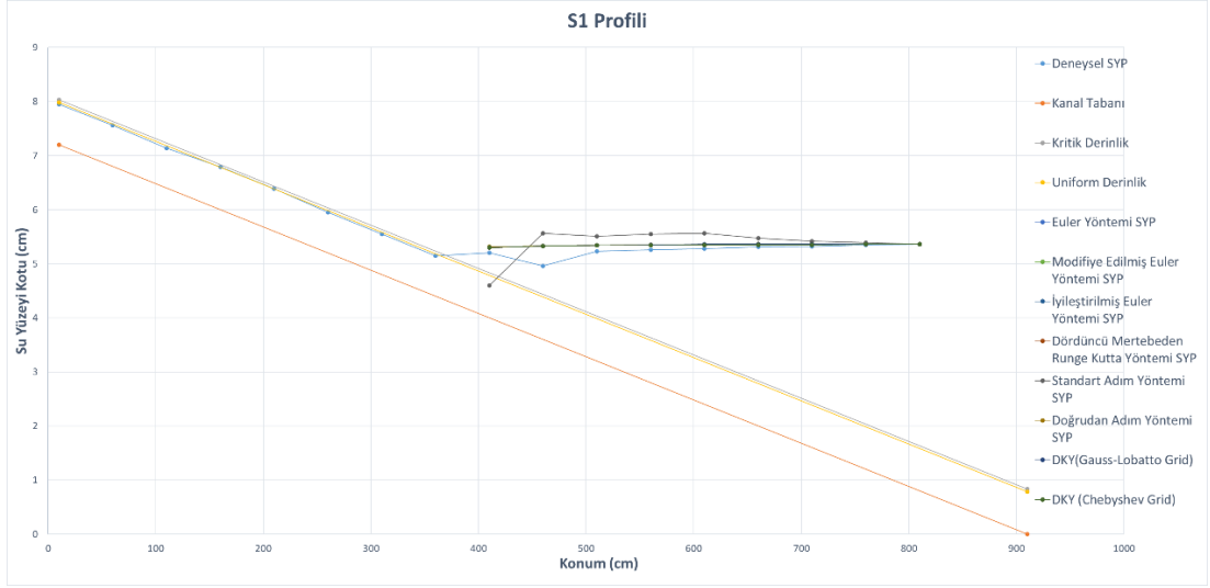
Şekil 6.51 1 numaralı S1 profiline ait deneysel ve sayısal çözümlerden elde edilmiş su yüzeyi profillerinin karşılaştırmalı gösterimi
