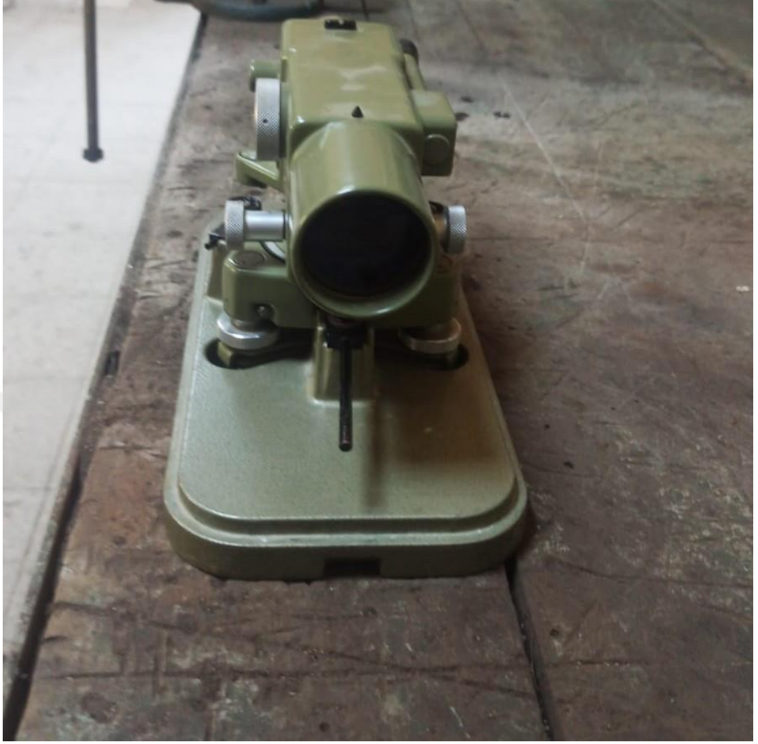
Şekil 5.6 Laboratuvarda bulunan ve kot ölçümünde kullanılan nivelman
