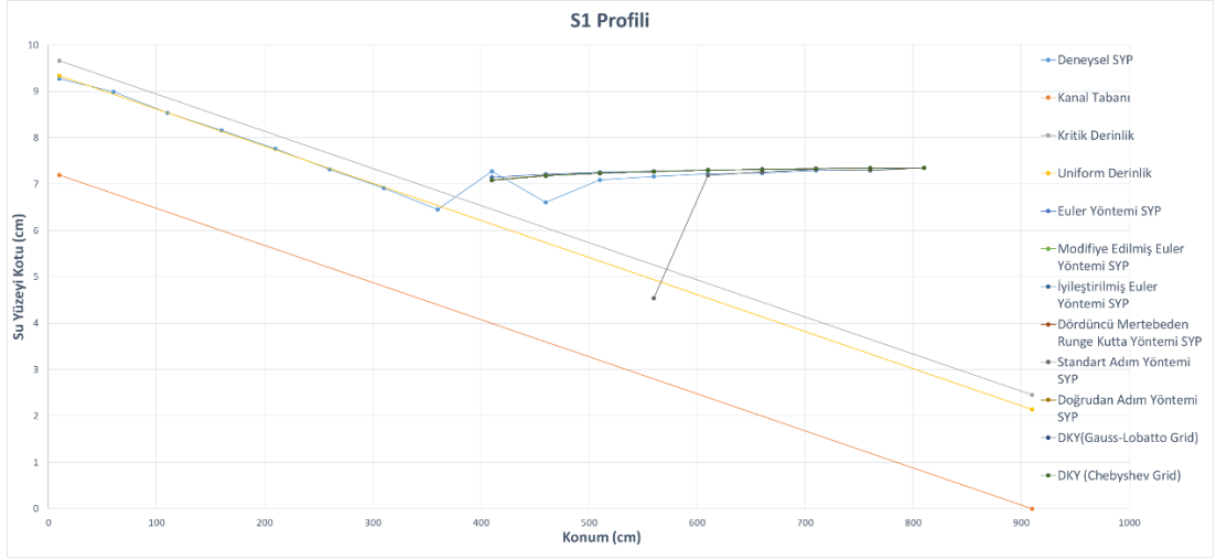
Şekil 6.55 3 numaralı S1 profiline ait deneysel ve sayısal çözümlerden elde edilmiş su yüzeyi profillerinin karşılaştırmalı gösterimi
