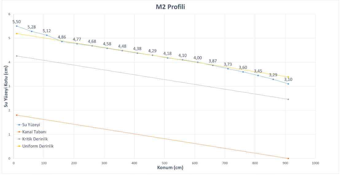
Şekil 6.6 Deneysel olarak oluşturulan 3 numaralı M2 profilinin boy kesitsel gösterimi
