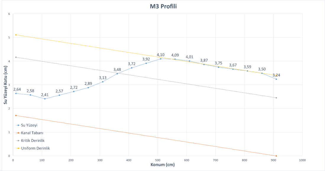
Şekil 6.12 Deneysel olarak oluşturulan 3 numaralı M3 profilinin boy kesitsel gösterimi
