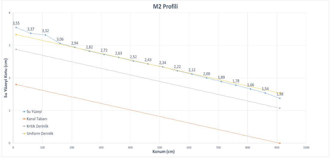
Şekil 6.4 Deneysel olarak oluşturulan 1 numaralı M2 profilinin boy kesitsel gösterimi
