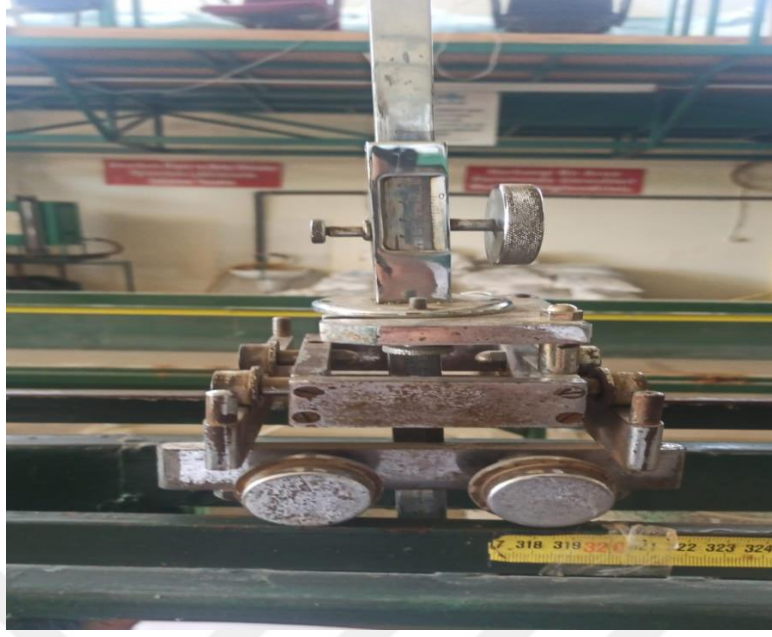
Şekil 5.5 Laboratuvarda bulunan ve derinlik ölçümünde kullanılan limnometre
