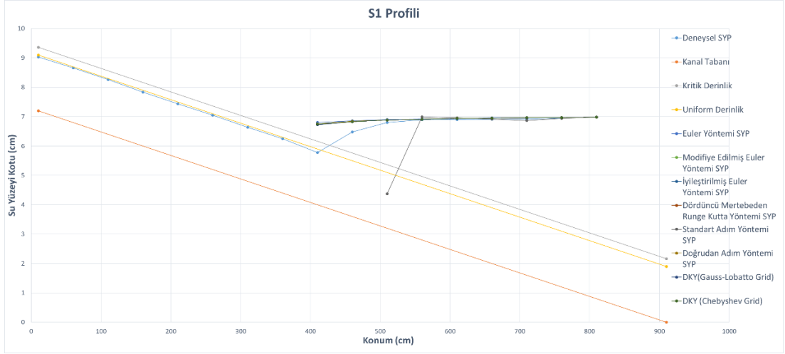
Şekil 6.53 2 numaralı S1 profiline ait deneysel ve sayısal çözümlerden elde edilmiş su yüzeyi profillerinin karşılaştırmalı gösterimi
