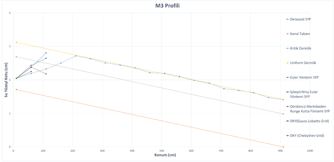
Şekil 6.41 1 numaralı M3 profiline ait deneysel ve sayısal çözümlerden elde edilmiş su yüzeyi profillerinin karşılaştırmalı gösterimi
