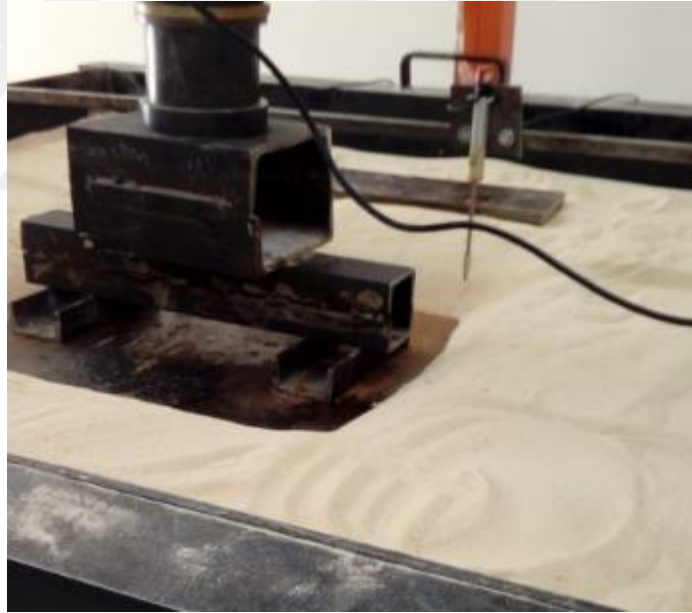
Şekil 5.7. Parçalanmış atık araç lastiklerinin yatak malzemesi olarak kullanıldığı deneyde zemin yüzeyinde meydana gelen aşırı oturma.
