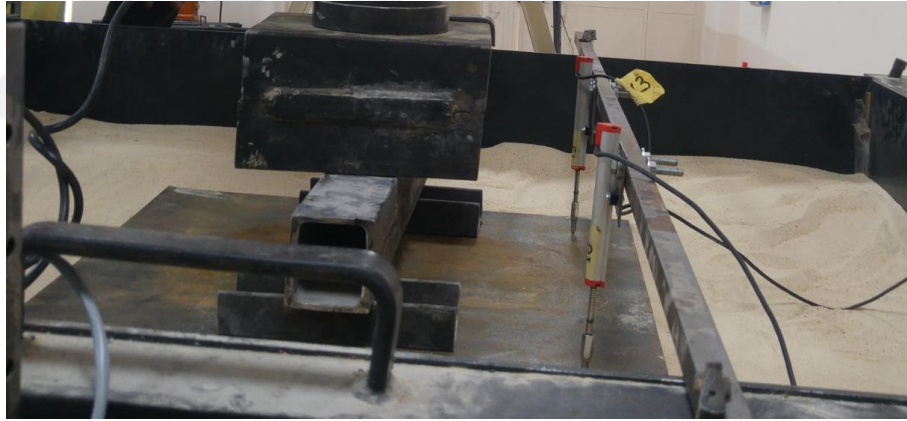
Şekil 4.22. Potansiyometrik cetveller ile yükleme plakası üzerinden oturma ölçümü.
