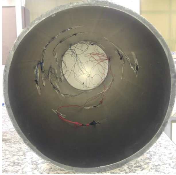
Şekil 4.26. Boru hattı L/2 ve L/4 kesitlerinde birim deformasyon ölçer yerleşimi.
