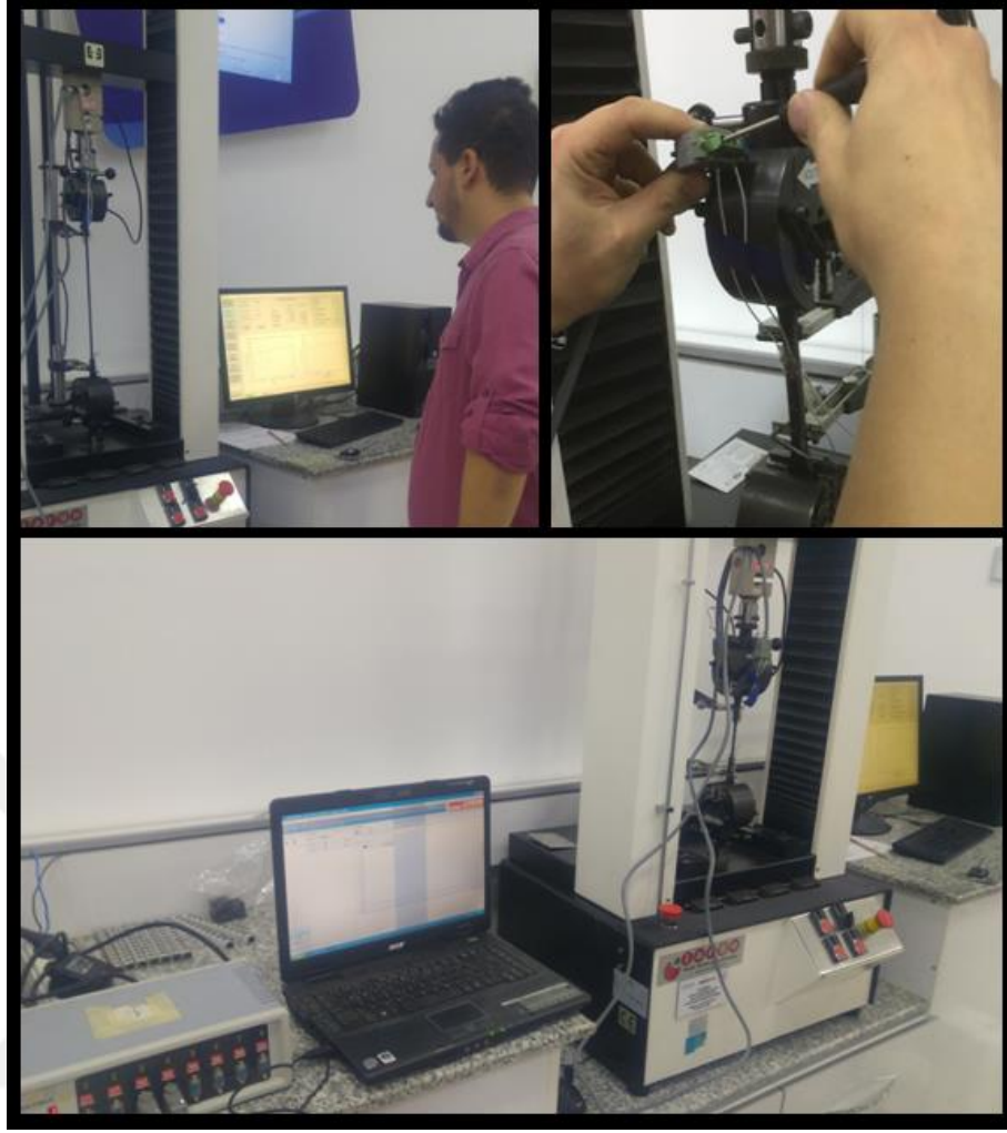
Şekil 4.10. Sabit hızda çekme testi ve şekil değiştirme ölçümü için kalibrasyon.
