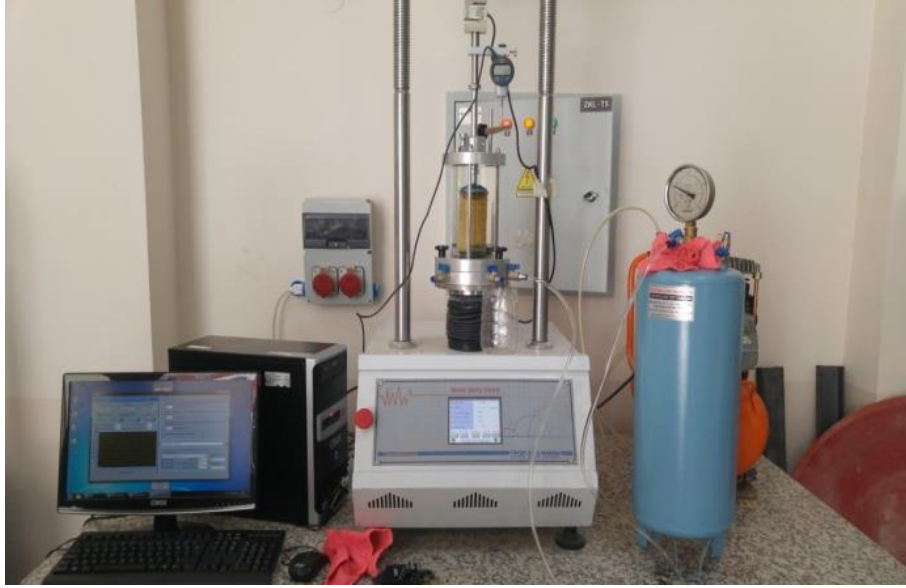
Şekil 4.9. Kayma mukavemeti parametrelerinin tayini için üç eksenli basınç deneyi.
