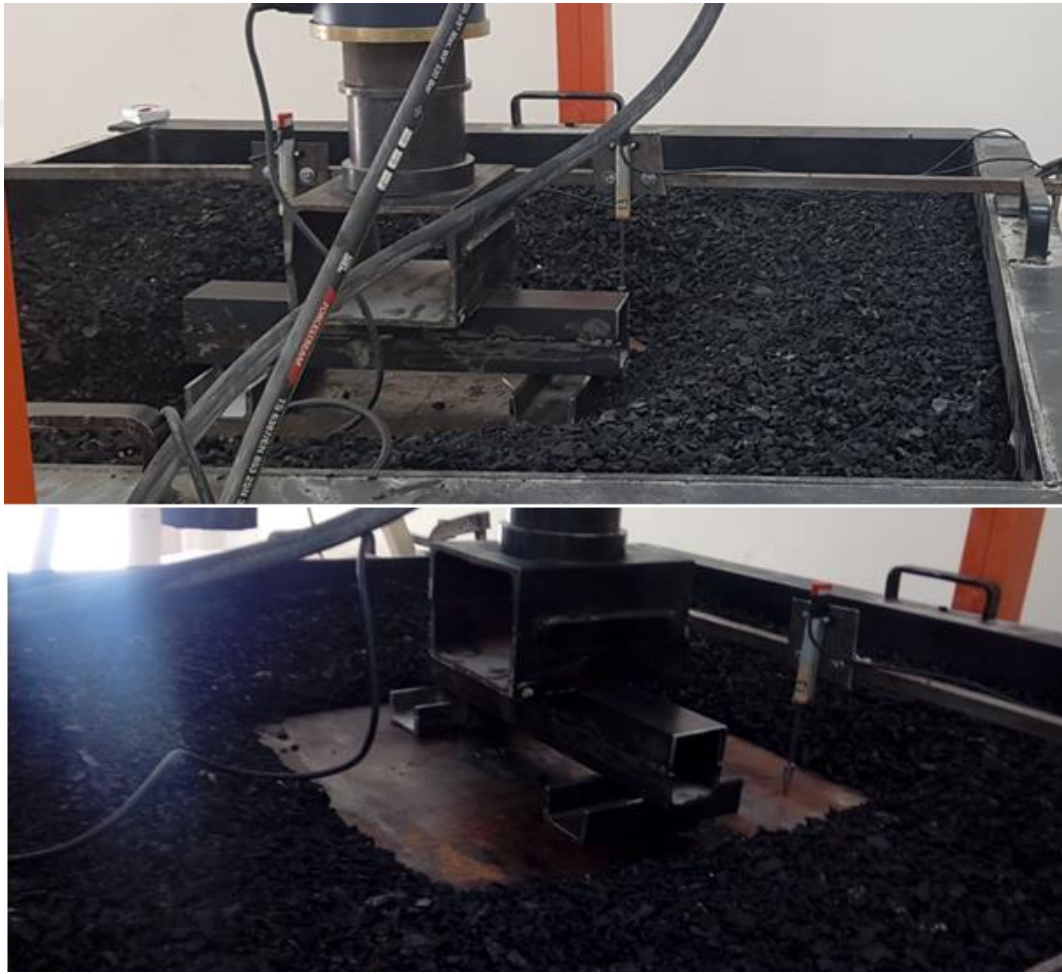
Şekil 5.6. Parçalanmış atık araç lastiklerinin üstdolgu olarak kullanıldığı deneyde zemin yüzeyinde meydana gelen oturma ve kabarmalar.
