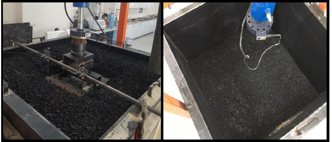
Şekil 4.17. Parçalanarak geri kazanılmış atık lastik parçaları ve granüllerin üstdolgu ve yatak malzemesi olarak kullanımı.
