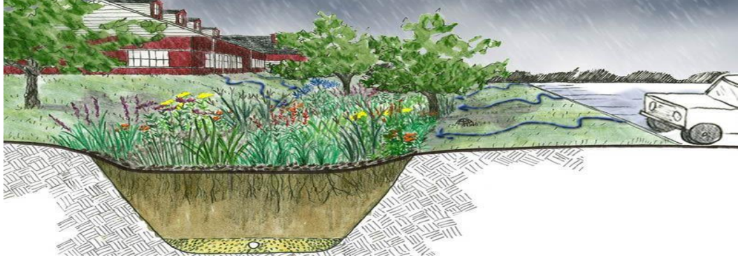
Şekil 36. Yol kenarına oluşturulan yağmur bahçesi örneği (Tokuş ve Özdemir, 2017)
