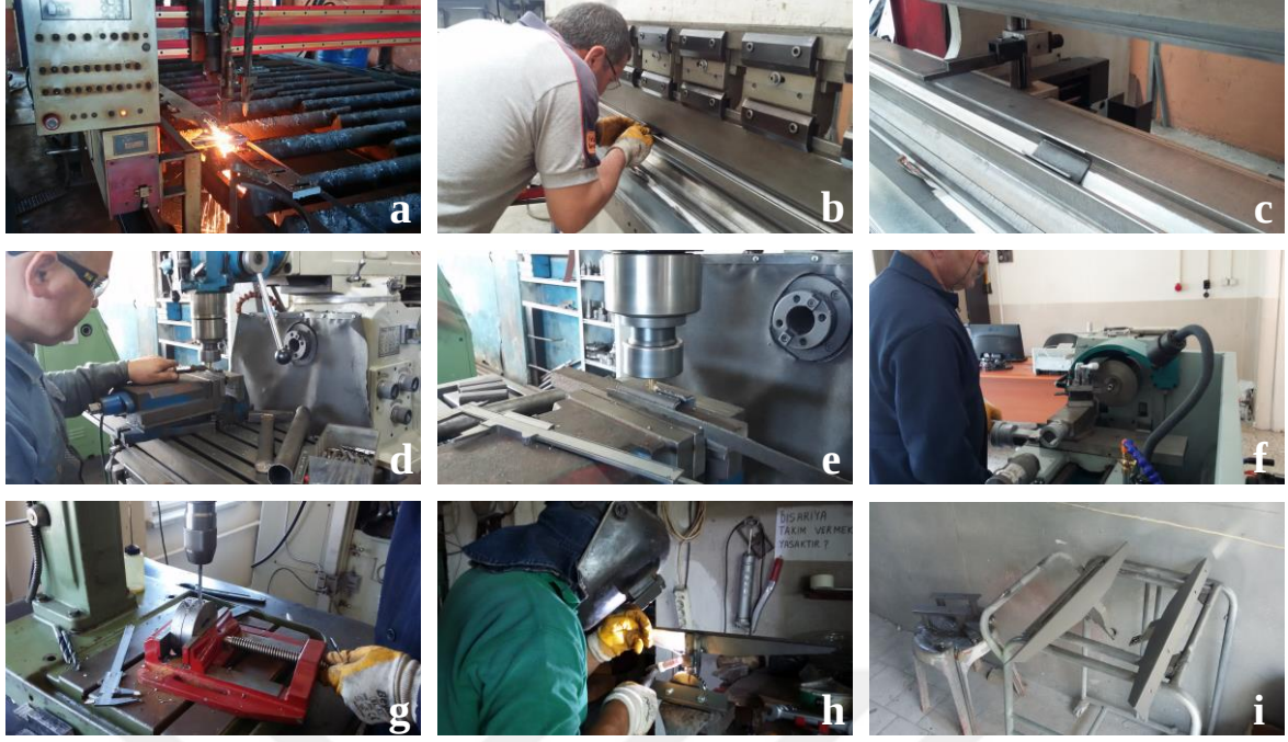
Şekil 24: Açılı katlanır masa mekanizmasının üretim aşamaları.
