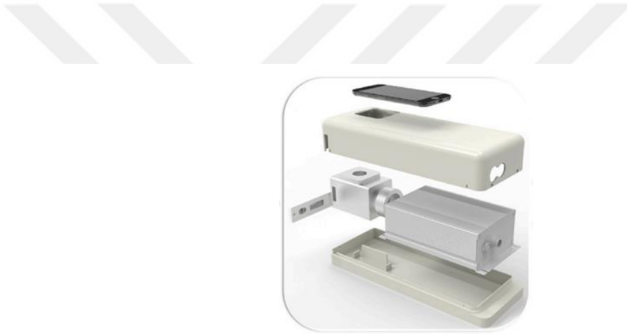
Şekil 2.1. Gong vd., genel amaçlı tasarladıkları portatif UCNP-LFA okuyucu (Gong vd. 2019)
