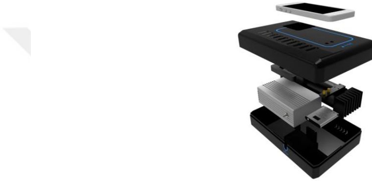
Şekil 2.4. You vd., BNP ve ST2 antijenlerini tespit etmek için tasarladıkları portatif UCNP-LFA okuyucu (You vd. 2017)
