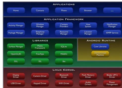
Şekil 1.9. Android işletim sisteminin katman yapısı (Burnette 2008)
