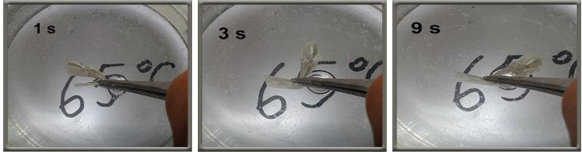
Şekil 6.15. SAMB'nin şekil hafızası davranışlarını gösteren bir dizi fotoğraf
