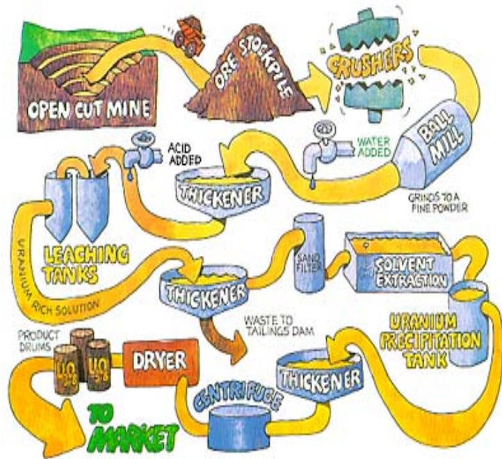
Şekil 2.3 Uranyum sarı pasta üretim akım şeması *
