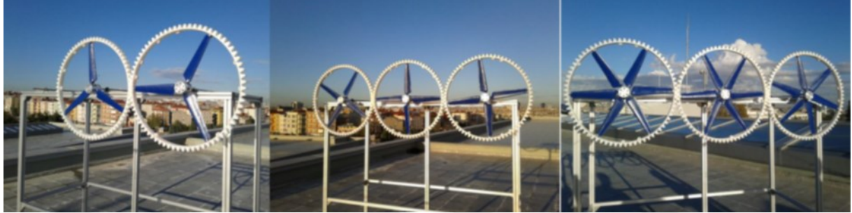
Resim 2.1. Farklı kanat sayısına sahip birbirine temas eden dişli yapıları türbin tasarımı (Kekezoğlu, 2013)
