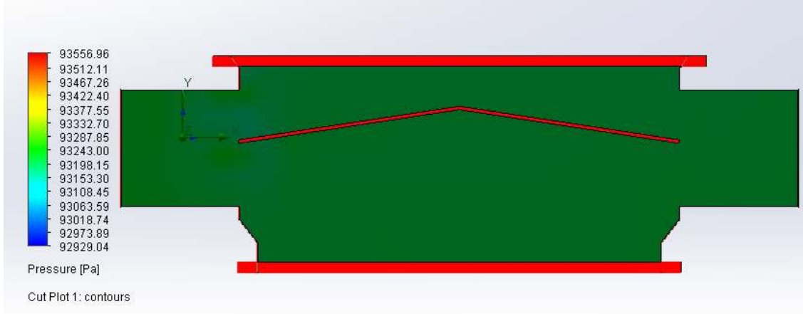
Şekil E.3.4. 4 numaralı tasarım yaz dönemi analizi basınç değişimi.
