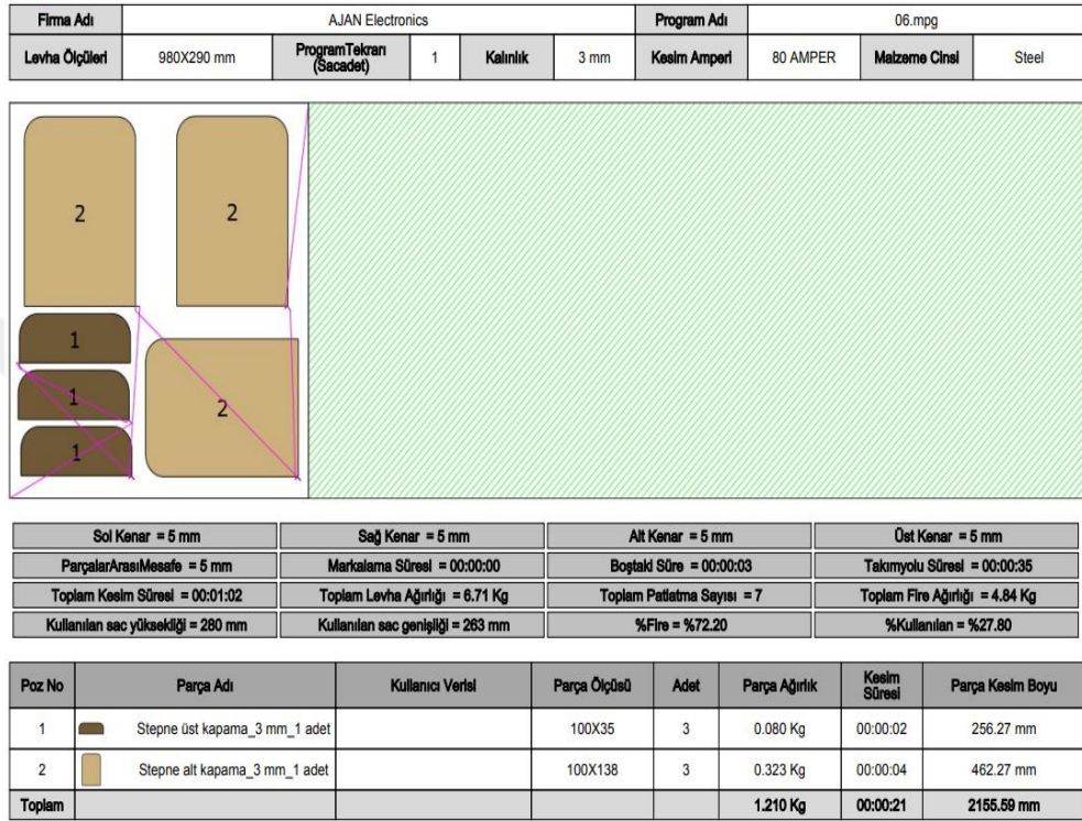
Şekil 4.5. Raylı transfer arabası CNC plazma kesim programı
