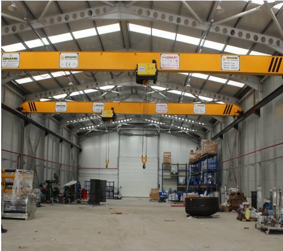
Şekil 1.1. Tavan vinci örneği ( https://www.ismakinesiehliyetsrc.com/ )
