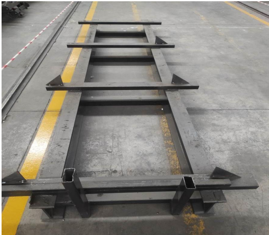
Şekil 4.12. Raylı transfer arabası kaynaklı birleştirme kalıbı
