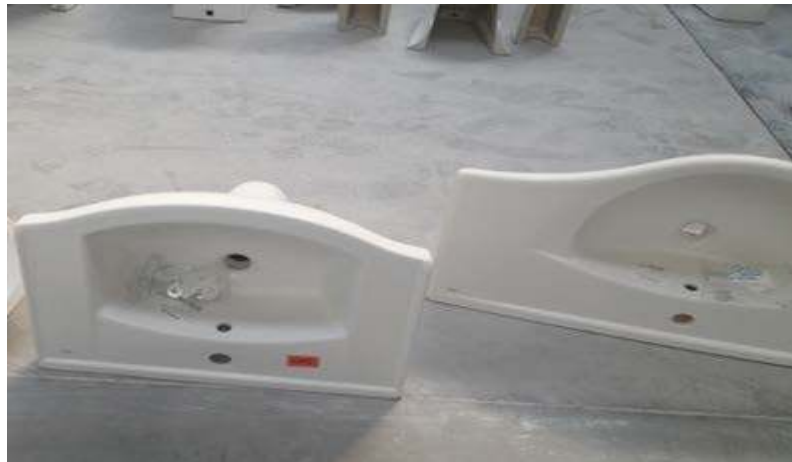
Şekil 35: Deformasyonlu Lavabo Örneği
