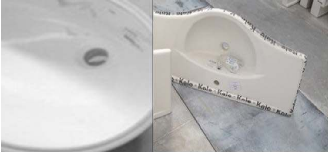
Şekil 38: Tezgah Üstü Lavabolardaki Deformasyon Örnekleri
