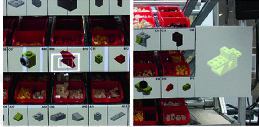
Şekil 6. Görüntü Projeksiyonlu AR'nin Montaj İstasyonunda Kullanımı
