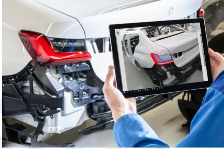
Şekil 9. Montajdan Sonra Parçaların İncelenmesi için AR Kullanımı
