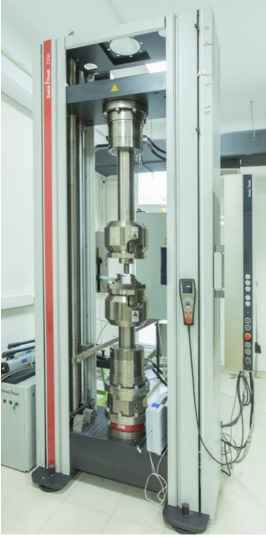
Resim 4.5. Zwick Z250Allround Universal Test cihazı
