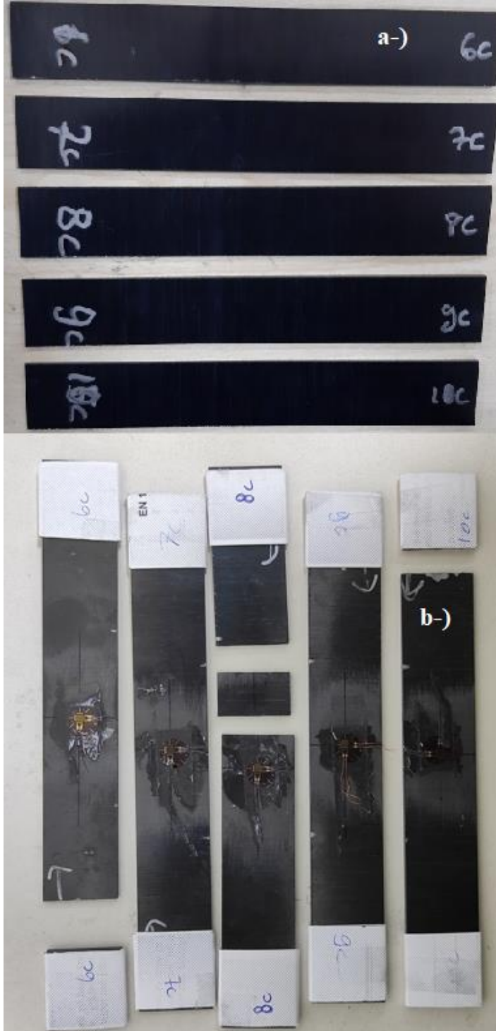
Resim 4.14. Kupon numune görselleri a-) test öncesi b-) test sonrası
