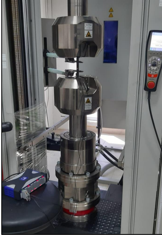
Resim 3.10. Gerinim ölçer bağlantısı ve veri toplama cihazı görseli
