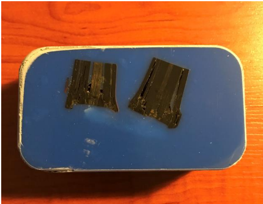
Resim 4.54. Bakalite alınmış muayene örneği
