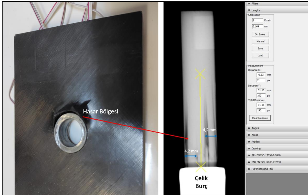
Resim 4.47. 2 numaralı numune hasar bölgesi X-ray görüntüsü
