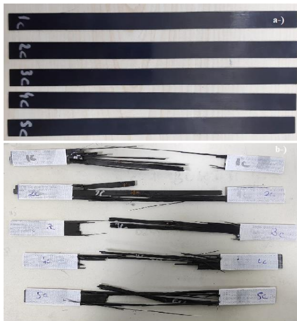
Resim 4.11. Kupon numune görselleri a-) test öncesi b-) test sonrası
