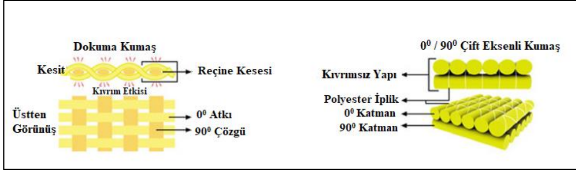
Şekil 2.4. Takviyeli dokuma ve çift eksenli kumaş arasındaki farklar [24]
