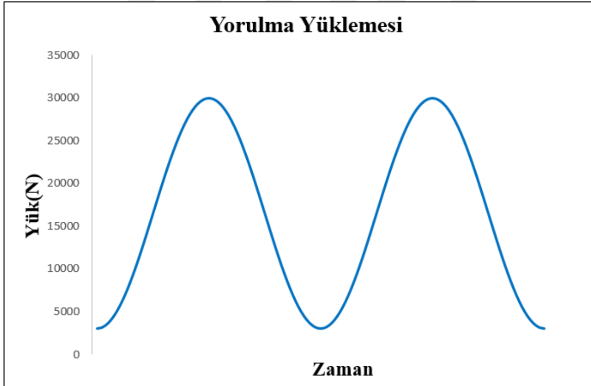
Şekil 4.35. Yorulma yükleme grafiği
