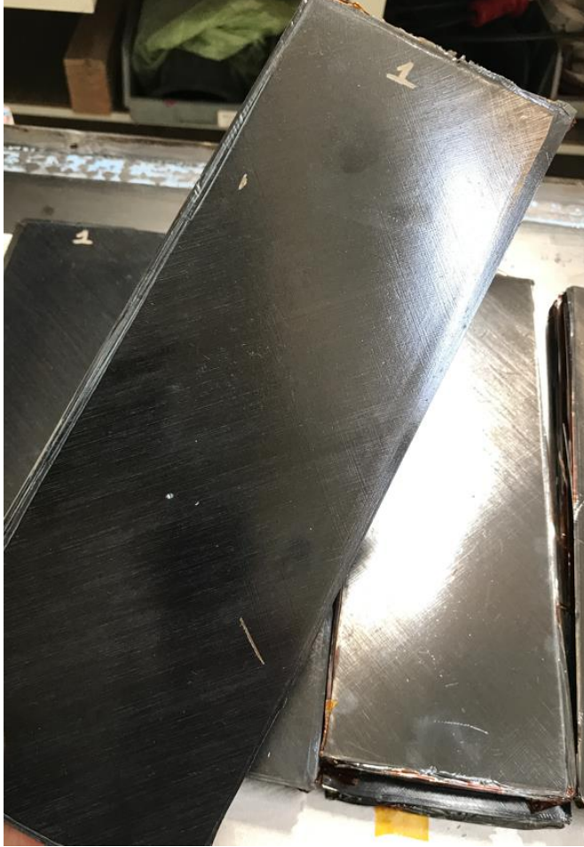
Resim 4.42. Otoklavdan çıkmış komponent numunesi
