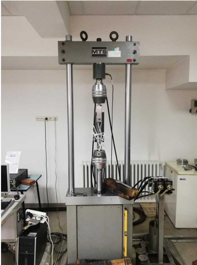
Resim 4.79. MTS 312.21 - 100 kN kapasiteli test cihazı
