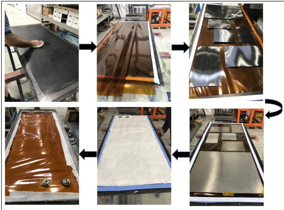
Resim 3.4. Takımın otoklav döngüsüne hazırlık döngüsü
