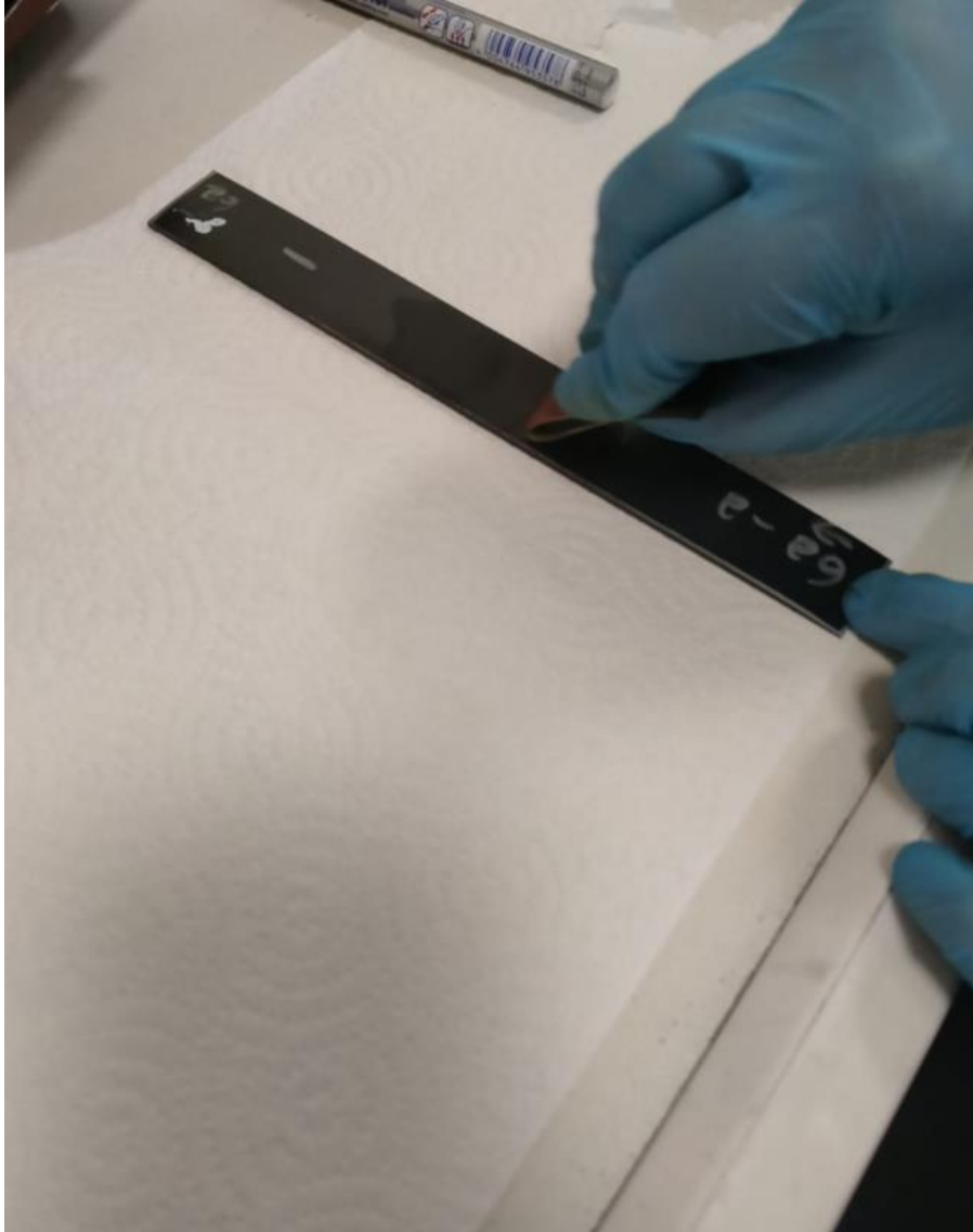
Resim 4.6. Gerinim ölçer yapıştırma işleminde zımparalama
