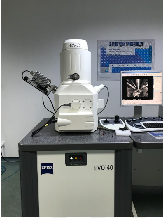
Resim 3.14. ZEISS Evo 40 SEM cihazı
