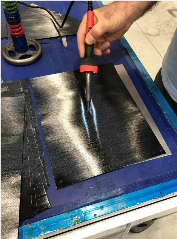
Resim 3.3. Tek yönlü karbon fiber PEKK bant üzerinden el ile kesim işlemi
