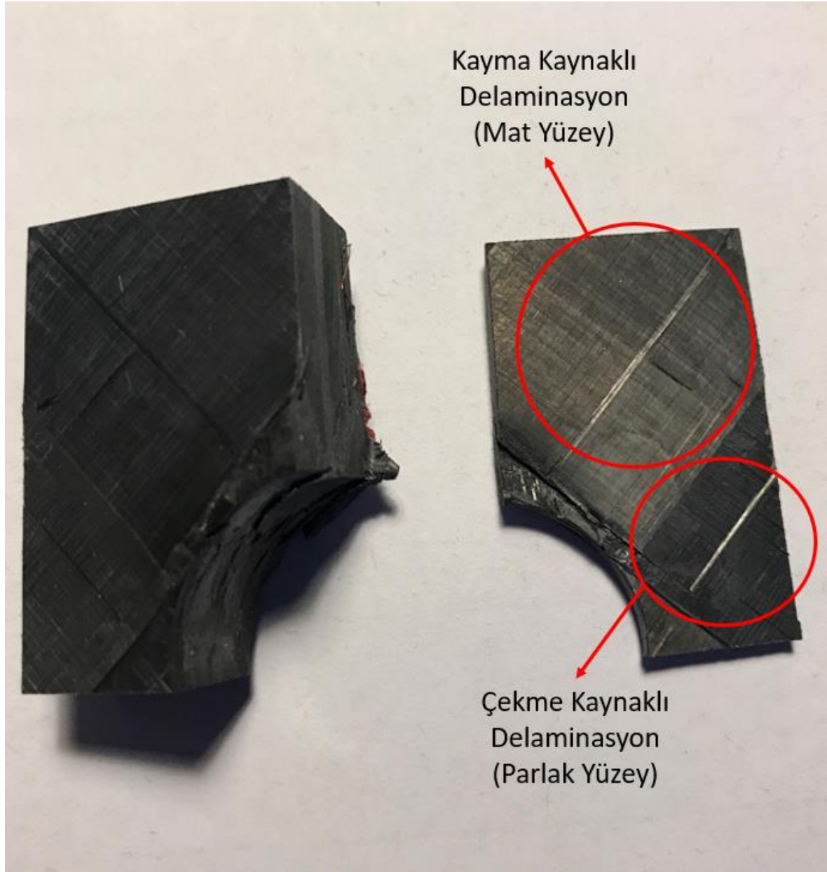
Resim 4.69. 4.1 numaralı komponent numunesine ait yüzey görüntüsü
