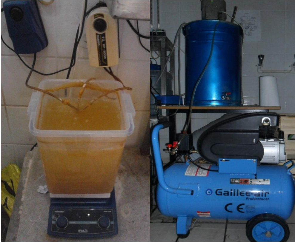
Şekil. 3.4. Pilot UMC Reaktörü ve Tam Karışımli Reaktör
