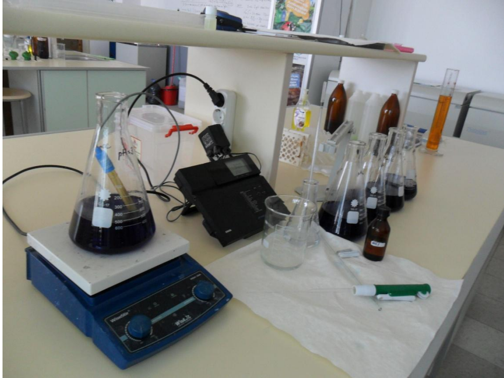
Şekil.3.10. Biyosorpsiyon öncesi sulu çözeltilerde farklı pH değerlerinin sağlanması
