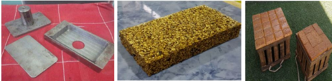
Resim 2.13. Zeytin atıkları ile oluşturulan kompozit ve demir kalıp ile üretilen ürünler (Farag, Alshebani, Elhrari, Klash, ve Shebani, 2020)
