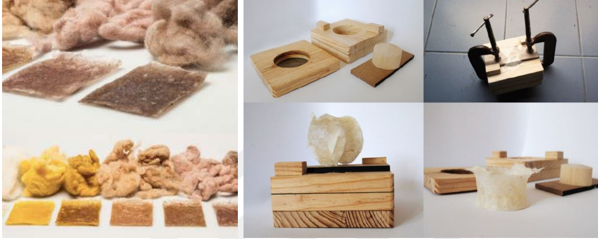
Resim 2.14. Yün lifleri ve nişasta ile oluşturulan NeWool biyo-kompoziti ve ahşap kalıp kullanılarak şekillendirilmesi (Rognoli, Ayala-Garcia, ve Parisi, 2016)
