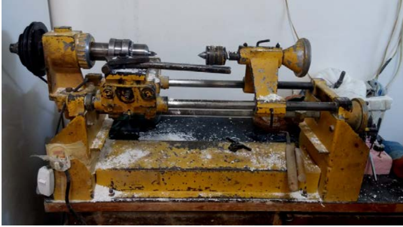
Resim 3.10. Lületaşı atölyesinde kullanılan torna tezgâhı
