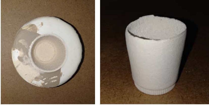
Resim 4.3. Lületaş tozu ve sodyum aljinat çözeltisi ile alçı kalıp üretim denemesi
