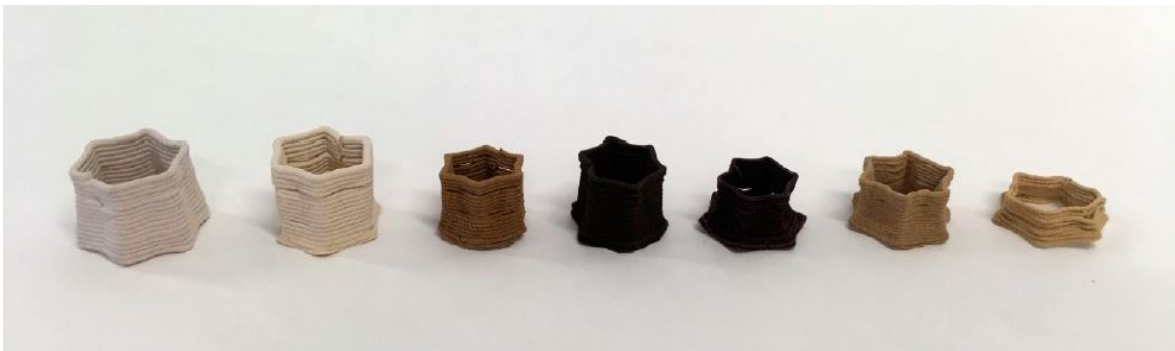
Resim 2.12. Doğal tabanlı malzemeler ile geliştirilmiş kompozitlerin 3 boyutlu yazıcı ile üretim denemeleri; malzemeler sırasıyla: midye kabuğu, yumurta kabuğu, ceviz kabuğu, zeytin atıkları, kakao kabuğu, akçaağaç talaşı, ahşap çam talaşı (Sauerwein, Zlopasa, Doubrovski, Bakker ve Balkenende, 2020).
