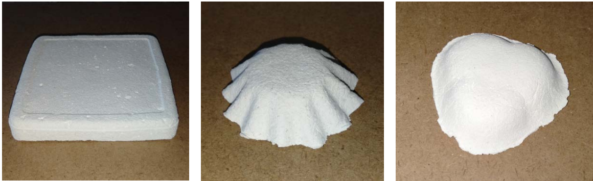
Resim 4.4. Sırasıyla plastik, metal ve porselen nesnelerin şekillendirme amacıyla kullanıldığı kalıp üretimi denemeleri
