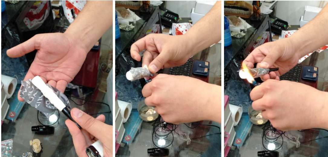
Resim 3.8. Lületaşından yapılmış sigara ağızlığının, ebru kağıdına sarılıp yakılarak renklendirilmesi
