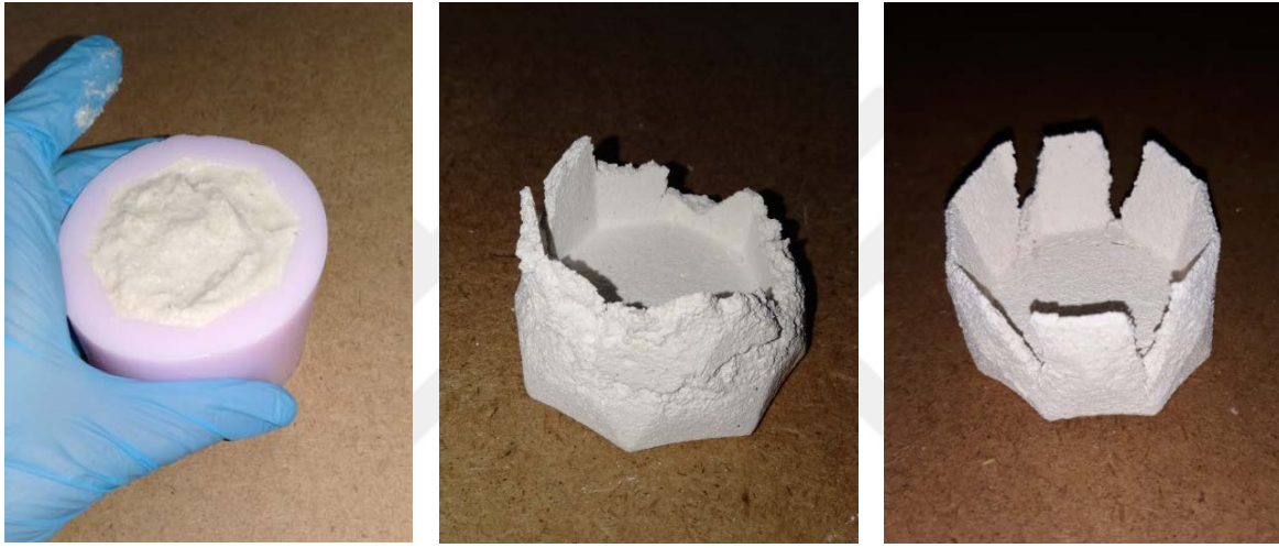
(a) (b) (c) Resim 4.2. Denemelerde kullanılan silikon kalıp (a), Lületaş tozu ve ksantan gam çözeltisi ile yapılan deneme (b), Lületaş tozu ve sodyum aljinat çözeltisi ile yapılan deneme (c)
